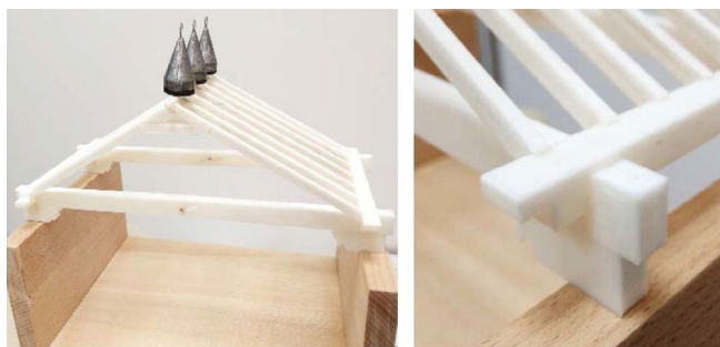
Figura 10. Modelo estructural a escala de una armadura de pares atirantados, construida siguiendo el tratado de López de Arenas (16) soportando peso y transmitiendo a los muros sólo cargas verticales.
