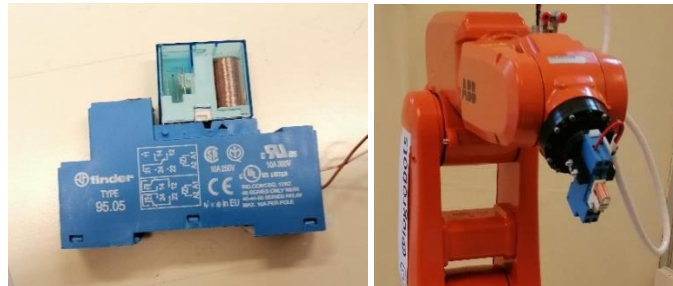
Figura 1. (a) Relé finder original y (b) robot sujetando el electroimán adaptado.
