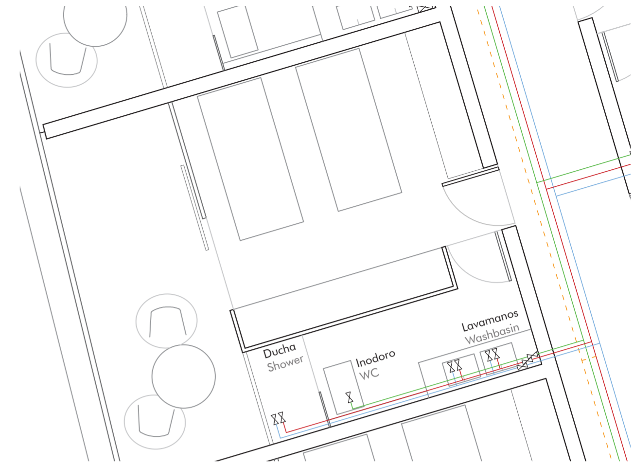
Detalle de la instalación en la habitación individual Installation detail in the single room E 1/50
