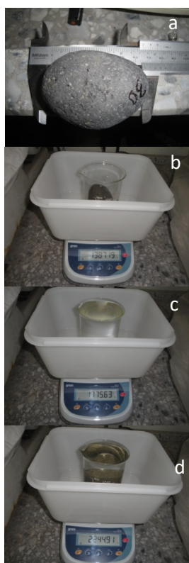
FIGURA 3. a) Medición de los ejes con un pié de rey. b) Primera pesada: canto. c) Segunda pesada: vaso enrasado de agua. d) Tercera pesada: vaso con el canto en su interior y enrasado con agua.
