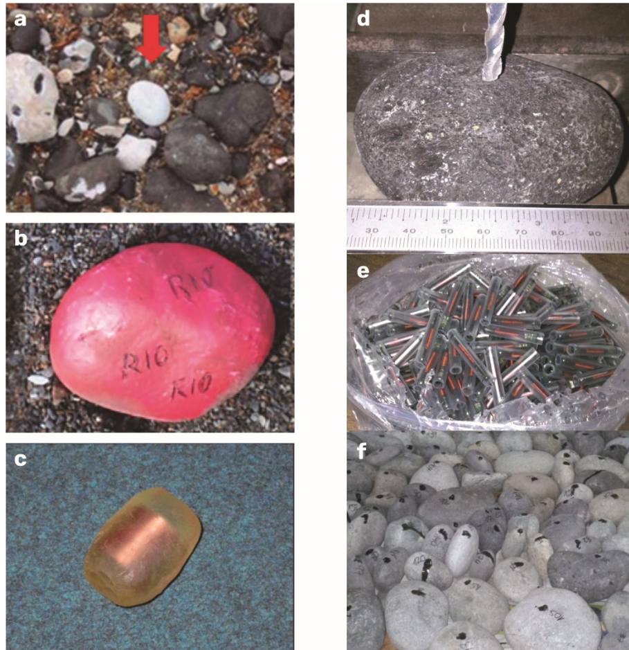
Figura 1.3. Ejemplos de los distintos tipos de trazadores utilizados en el estudio del transporte sedimentario en playas de cantos: a) Trazadores de litologías exóticas. Fuente: Curoy (2012). b) Trazadores con pintura fluorescente. Fuente: Stark and Hay (2016). c) Trazador sintético creado a partir de resina epoxi con transmisión por radio de la ubicación. Fuente: Curoy (2012). Proceso de preparación de los trazadores pasivos, sistema RFID: d) Perforación de los cantos seleccionados. e) Transpondedor pasivo con número de identificación único para cada trazador introducidos en un tubo de plástico para su protección. f) Sellado con resina epoxi una vez introducidos los transpondedores. Fuente: elaboración propia.
