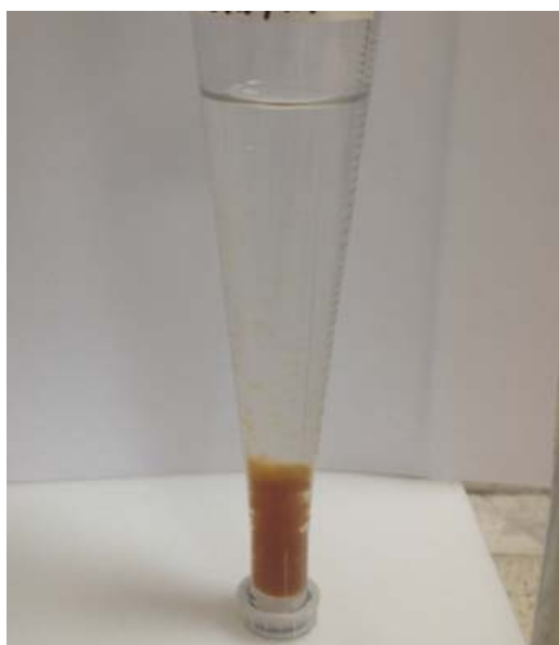
Figura 7.30. Medición del volumen de lodos generados luego del tratamiento de Fenton.
