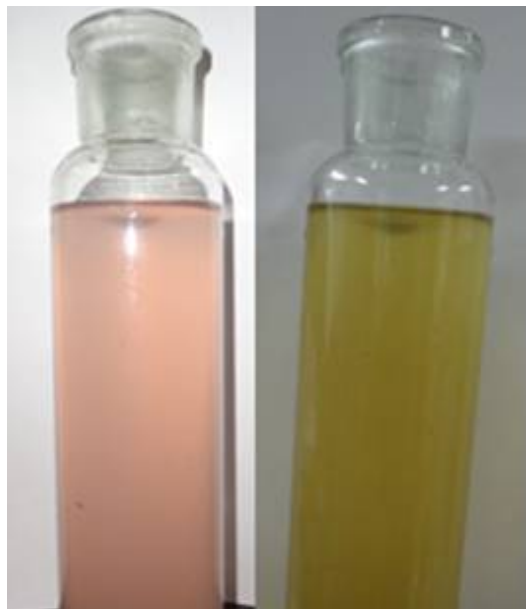
Figura 6.13. Efluente original regulado a pH 3 (izquierda), y efluente con 100 mM H 2 O 2 y 2.5 mM Fe(II) al inicio de la reacción (derecha).
