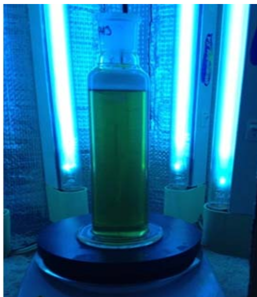
Figura 7.25. Aspecto de muestra durante el tratamiento de foto-Fenton aplicando 200 mM \text{H}_2\text{O}_2 y 3 mM \text{Fe(II)} ; pH 3, T=25^\circ\text{C} .
