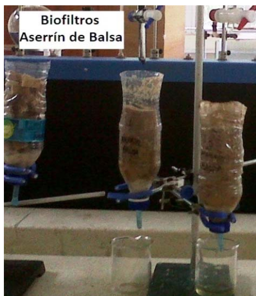
Figura 6.26. Biofiltro de aserrín de balsa blanca a escala de laboratorio empleado en las pruebas.
