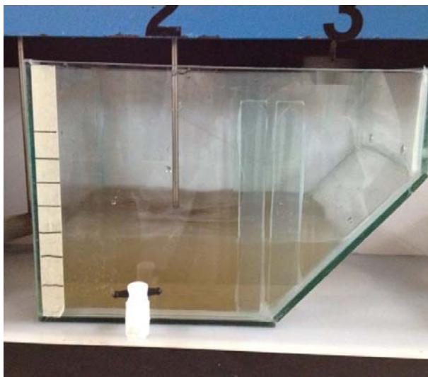
Figura 6.21. Reactor de 5 L de capacidad con agitación continua para el tratamiento de Fenton del efluente de la industria de alimentos.
