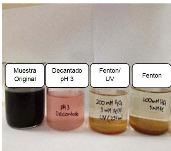
Figura 7.27. Aspecto de muestras decantadas a pH 3, y posteriormente tratadas con los tratamientos de Fenton y foto-Fenton aplicando 200 mM \text{H}_2\text{O}_2 y 3 mM \text{Fe(II)} .
