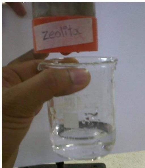
Figura 7.37. Muestra luego de ser filtrada por zeolita. Obsérvese la transparencia de la muestra.
