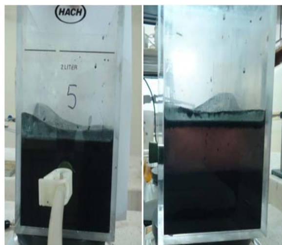
Figura 7.5. Al inicio (izquierda) y luego de 30 minutos (derecha) de la regulación del pH a 3 del efluente de la industria gráfica.
