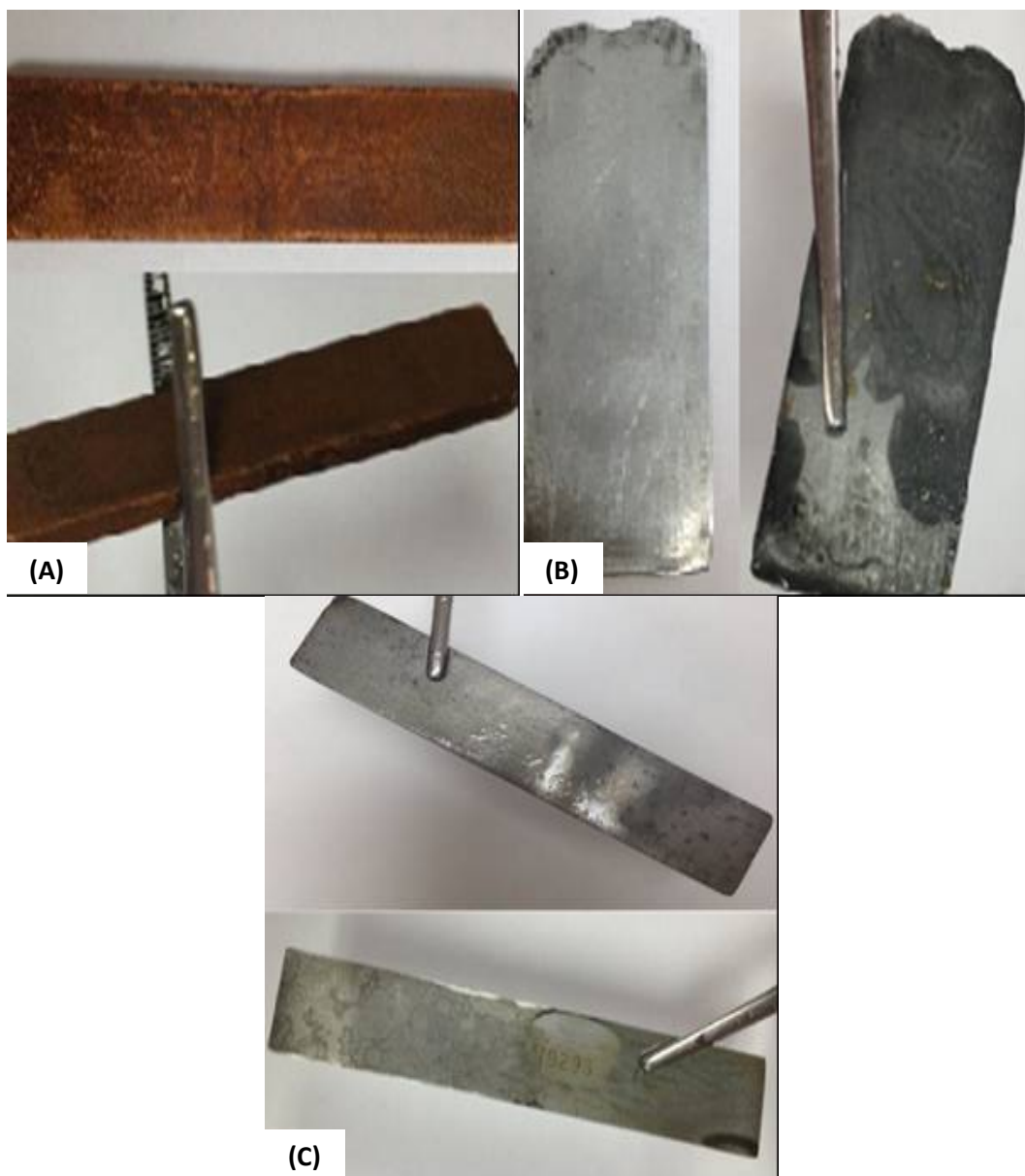
Figura 6.24. Aspecto de las láminas empleadas en la prueba de corrosividad: a) cobre, b) zinc, y c) hierro; antes (izquierda) y después (derecha) del ensayo con lodos generados en las reacciones de Fenton.
