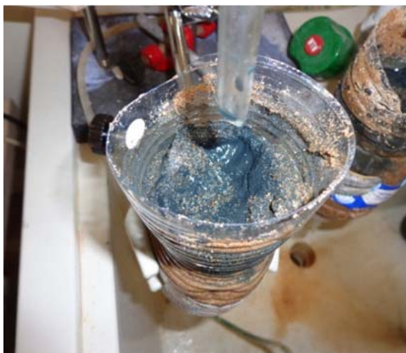
Figura 7.38. Lodos del efluente en la superficie del filtro de arena con bacterias
