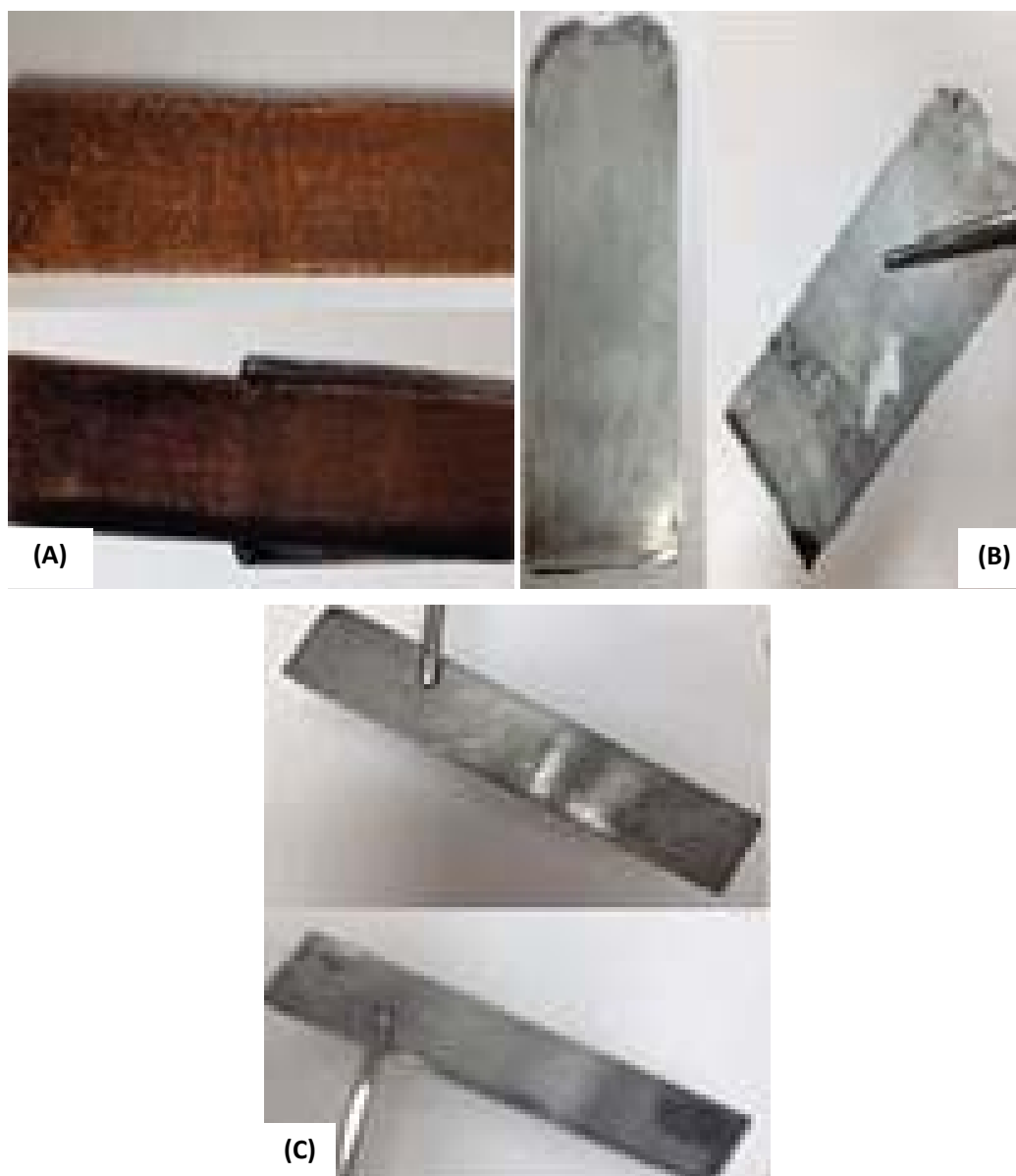
Figura 7.32. Aspecto de las láminas empleadas en la prueba de corrosividad: a) cobre, b) zinc, y c) hierro; antes (izquierda) y después (derecha) del ensayo con lodos generados en las reacciones de Fenton.
