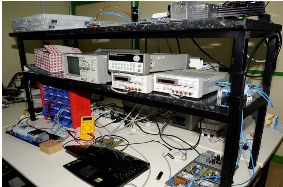
Figura 3.3. Equipo de medida utilizado para analizar los EDLCs.
