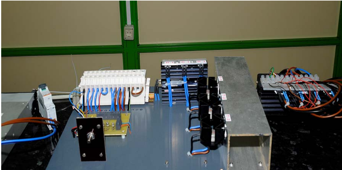
Figura 3.5. Bloque de referencia, fuente de corriente y puente de interruptores.
