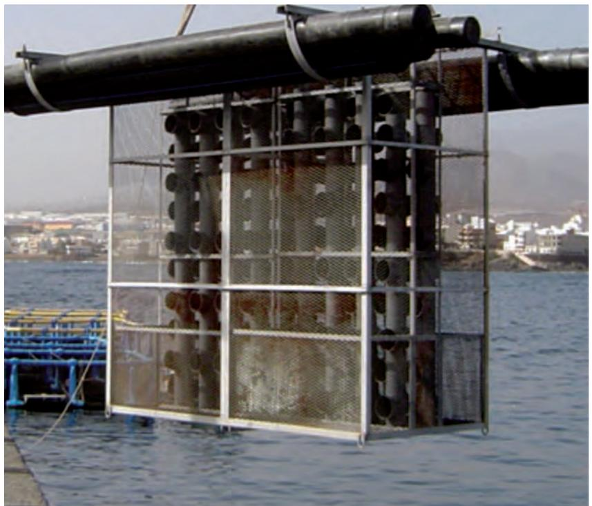
**Figura 5.** Jaula sumergible de 4 m<sup>3</sup>, situada a 27 m de profundidad, subdividida interiormente en 2 semi-jaulas de 2 m<sup>3</sup>, cada una con 26 guaridas
