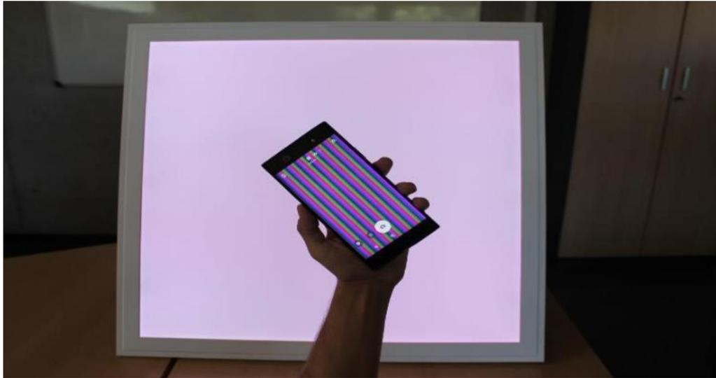
Figura 1. Efecto RS inducido por una lámpara LED RGB que conmuta la secuencia R, G y B (foto en el IDeTIC).
