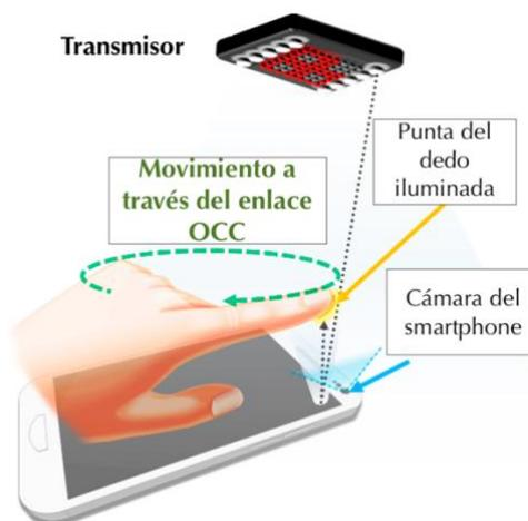
Figura 31. Esquema de movimiento sobre la cámara [106].
