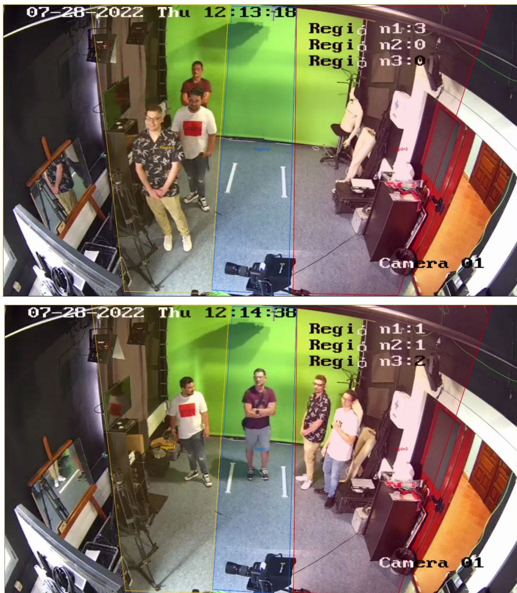
Figura 82. Prueba con la interfaz de la cámara de gestión de colas Fuente: Elaboración propia
