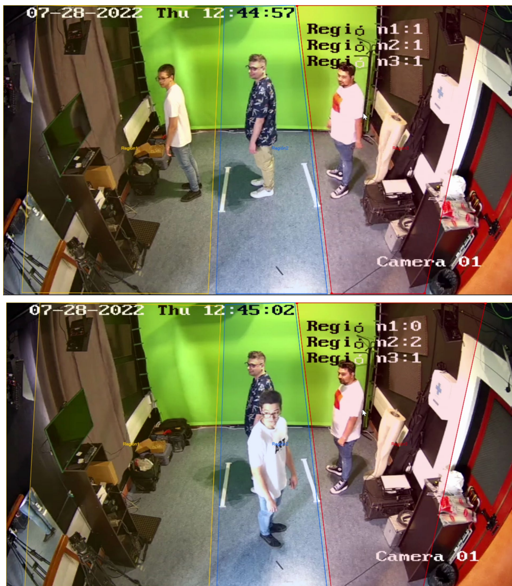
Figura 83. Prueba con la interfaz de la cámara de gestión de colas Fuente: Elaboración propia
