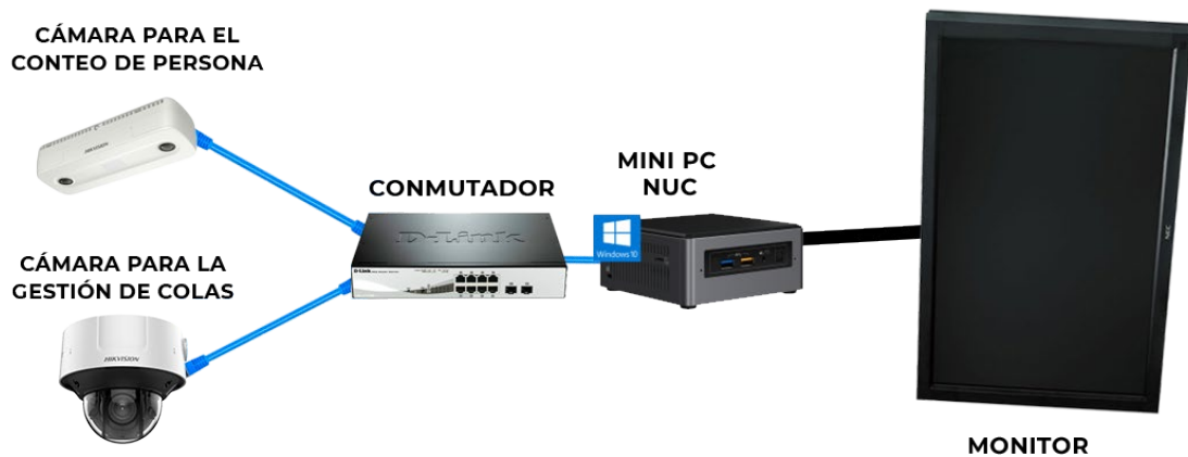
Figura 61. Esquema general hardware de señalización digital Fuente: Módulo Digital Signage del Servicio Web (Elaboración propia)
