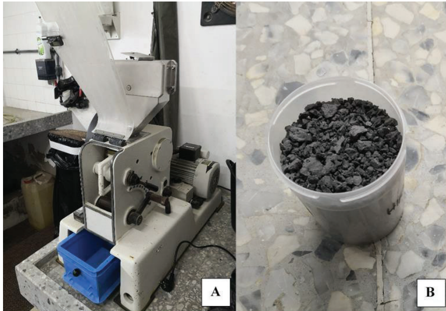
Figura 5: A) Machacadora operativa en el taller de geología de la facultad de Ciencias Básicas. B) Ejemplo del resultado una vez que los tacos de la muestra han sido machacados.
