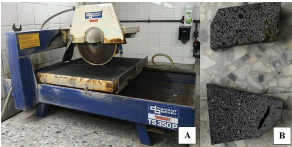
Figura 4: A) Sierra para cortar la muestra en tacos operativa en el taller de geología. B) Ejemplo de tacos cortados por la sierra de la muestra anteriormente mencionada.
