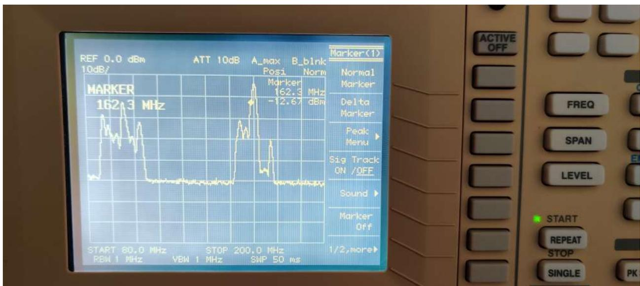
Figura 6.28: Espectro de la banda VHF tras incorporar el módulo.
