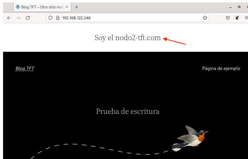
Ilustración 7.98: Verificación del balanceo de carga del servicio después de recargar
