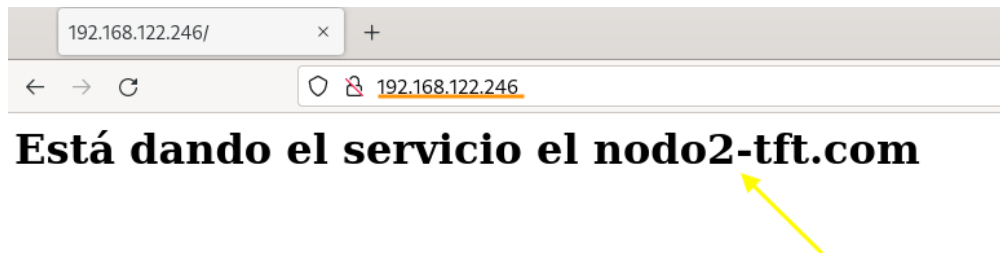
Ilustración 7.35: Verificación del balanceo de carga con el Nodo2-servicio
