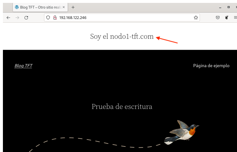
Ilustración 7.97: Verificación del balanceo de carga del servicio
