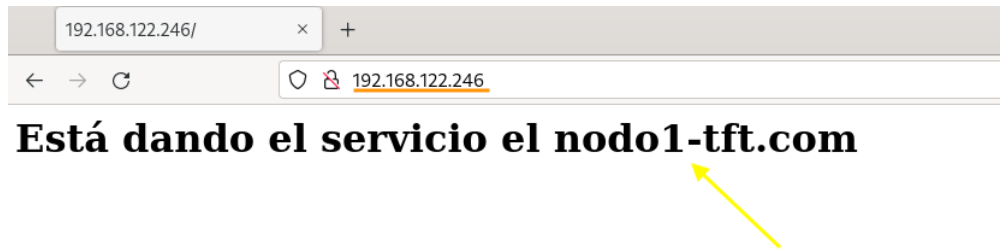
Ilustración 7.34: Verificación del balanceo de carga con el Nodo1-servicio
