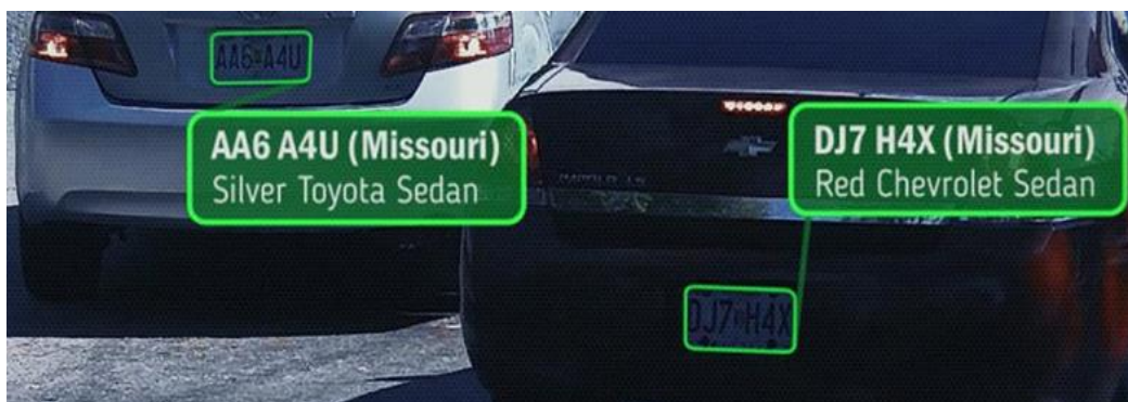
Figura 2.4. OCR aplicado a matrículas de vehículos
