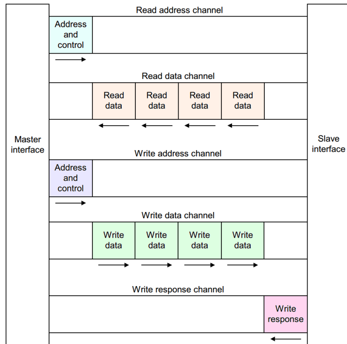
Figura 2 Arquitectura de comunicación AXI [8]
