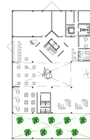
HOTEL: ESTRUCTURA MIXTA. FORJADO RETICULAR de luces de 5,25 m.y 10,50 m. para planta baja y primera planta. Resto de las plantas cuelgan de unas CERCAS METÁLICAS situadas en cubierta y apoyadas en unas pantallas de hormigón armado.
