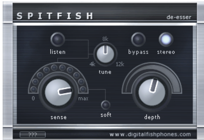
Fig.3.7. De-esser Spitfish. Se puede tomar la frecuencia principal (tune), en este caso de 8 kHz la sensibilidad (sense), cercana al máximo, y la potencia del efecto (depth), que se ha elegido media-alta. También está activada la opción stereo puesto que los archivos están en este formato.
