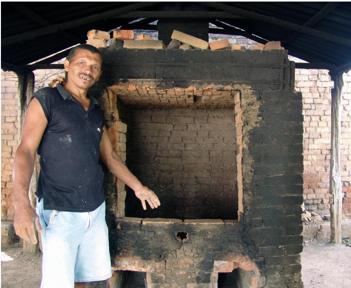
Fotografías 7.18 y 7.19: Fábrica de la Cerámica Roja (Baracoa, Cuba). Horno de leña. Se trata de un horno de oxidación, que alcanza los 900° C. En un primer plano de la primera imagen, se encuentra el motor y la tubería bifurcada para inyectar aire en la cámara de combustión, en donde se encontraría la leña. En la imagen de abajo, detalles del interior de la cámara de guisado. Capturas del 19 de julio de 2007.
