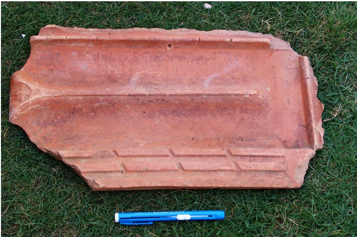
Fotografías 6.143 y 6.144: reverso y anverso de una teja francesa, fabricada en Marsella (Francia), que fue utilizada en una construcción de la Ciudad de Baracoa, y que pertenece al fondo de documentación del Museo de Baracoa (Cuba). Capturas del 18 de julio de 2007.
