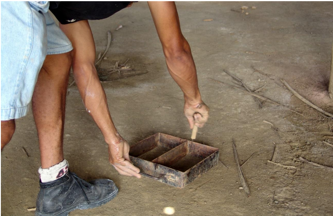
Fotografía 7.5: Fábrica de la Cerámica Roja (Baracoa, Cuba). Simulación de desprendimiento de dos ladrillos (antes del secado), desde sus moldes, con la utilización de una aguja. Captura del 19 de julio de 2007.
