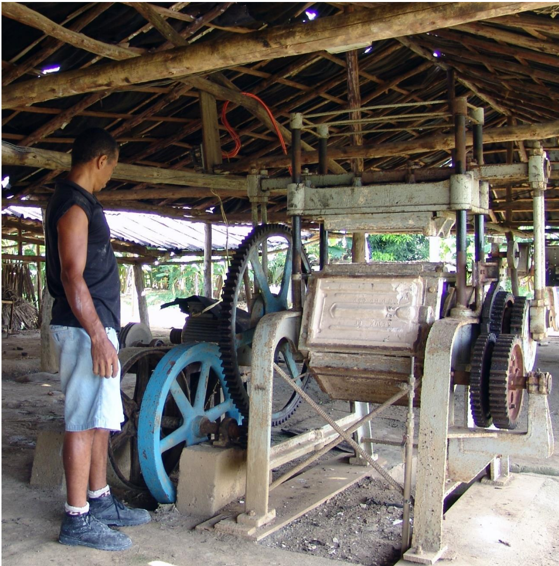
Fotografía 7.7: Fábrica de la Cerámica Roja (Baracoa, Cuba). Máquina para fabricar tejas francesas. Los bordes metálicos de la máquina enmarcan al molde reverso, en yeso, de la teja. Captura del 19 de julio de 2007.
