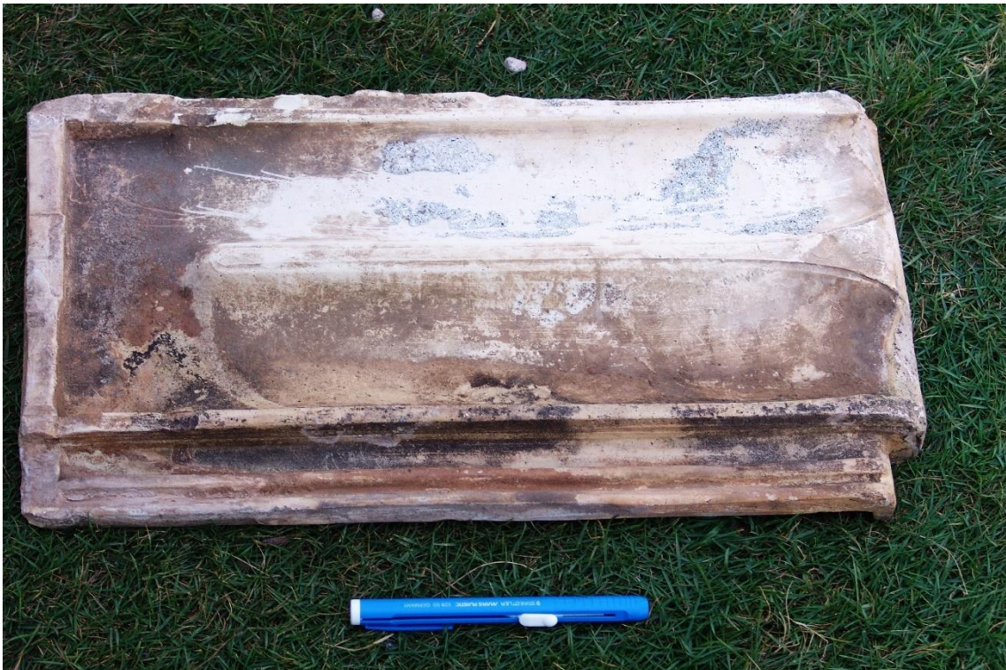
Fotografías 6.153 y 6.154: reverso y anverso de una teja francesa, fabricada en Alicante (España), que fue utilizada en una construcción de la Ciudad de Baracoa, y que pertenece al fondo de documentación del Museo de Baracoa (Cuba). Capturas del 18 de julio de 2007.
