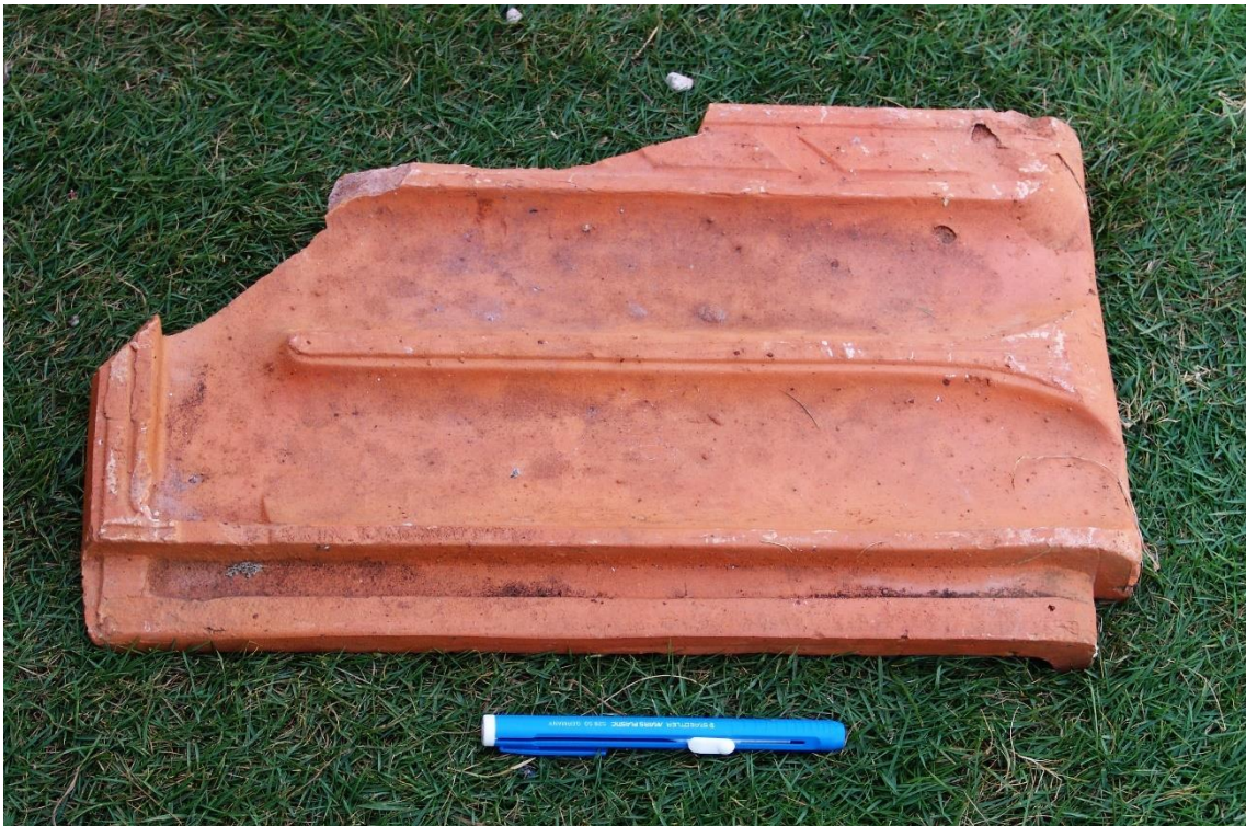
Fotografías 6.159 y 6.160: reverso y anverso de una teja francesa, fabricada en Pinar del Río (Cuba), que fue utilizada en una construcción de la Ciudad de Baracoa, y que pertenece al fondo de documentación del Museo de Baracoa (Cuba). Capturas del 18 de julio de 2007.
