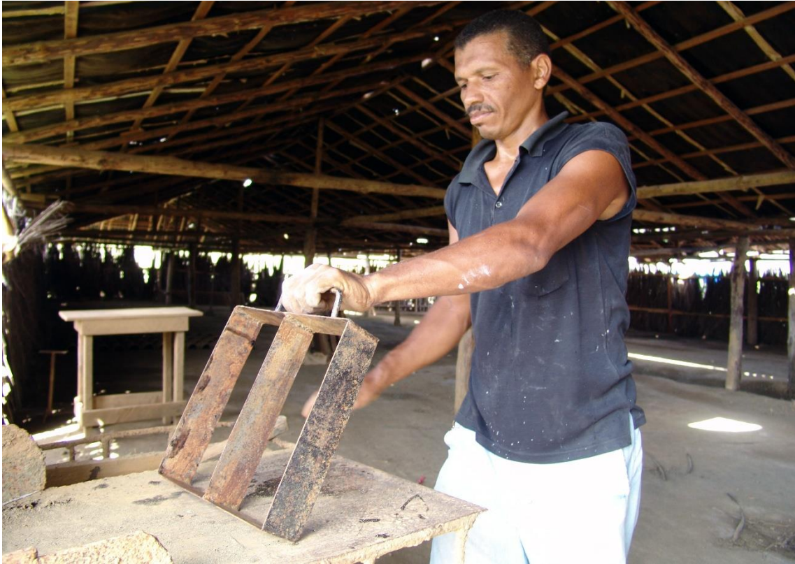
Fotografía 7.4: Fábrica de la Cerámica Roja (Baracoa, Cuba). Nave de desecado y de trabajo manual. En primer plano, mesa para la fabricación de ladrillos. Don Rodolfo Pileta Delgado sostiene un molde de dos ladrillos. Captura del 19 de julio de 2007.
