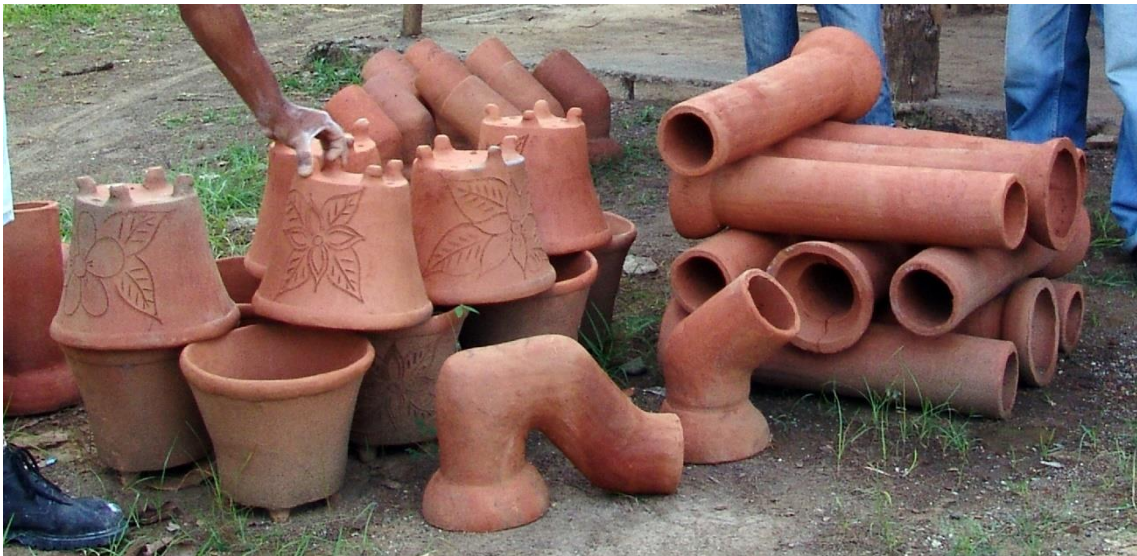
Fotografía 7.26: Fábrica de la Cerámica Roja (Baracoa, Cuba). Piezas guisadas (tuberías, codos y macetas). Los materiales de construcción, como los fabricados en esta alfarería de Baracoa, con térreos arcillosos, son más sostenibles que sus alternativos, procedentes de derivados del cemento y del petróleo (los PVC, por ejemplo), a pesar de que, para la producción de las piezas cerámicas, se provoquen cicatrices geomorfológicas por la explotación de sus materias primas, y se expulsan humos con dióxido de carbono durante los procesos de guisado en los hornos (si la fuente de energía es la leña). Esta contaminación ambiental resulta relativamente menor que la que originan las cementeras y las refinerías de petróleo, por sus expulsiones adicionales de gases dañinos a la salud de los seres vivos (incluida la salud del Hombre), y de micro partículas sólidas, asimismo perjudiciales para la salud. Además, las industrias del cemento y del petróleo no están eximidas de producir también daños en la Naturaleza, para disponer de sus materias primas (por ejemplo, cicatrices geomorfológicas para el caso de las cementeras) Martínez y Casas (2021), describen, de forma sucinta, los impactos ambientales de las cementeras, referenciadas a un caso en particular. La debilidad de los materiales de las alfarerías está en sus mayores fragilidades (se rompen con más facilidad), en comparación con los materiales alternativos. Captura del 19 de julio de 2007.
