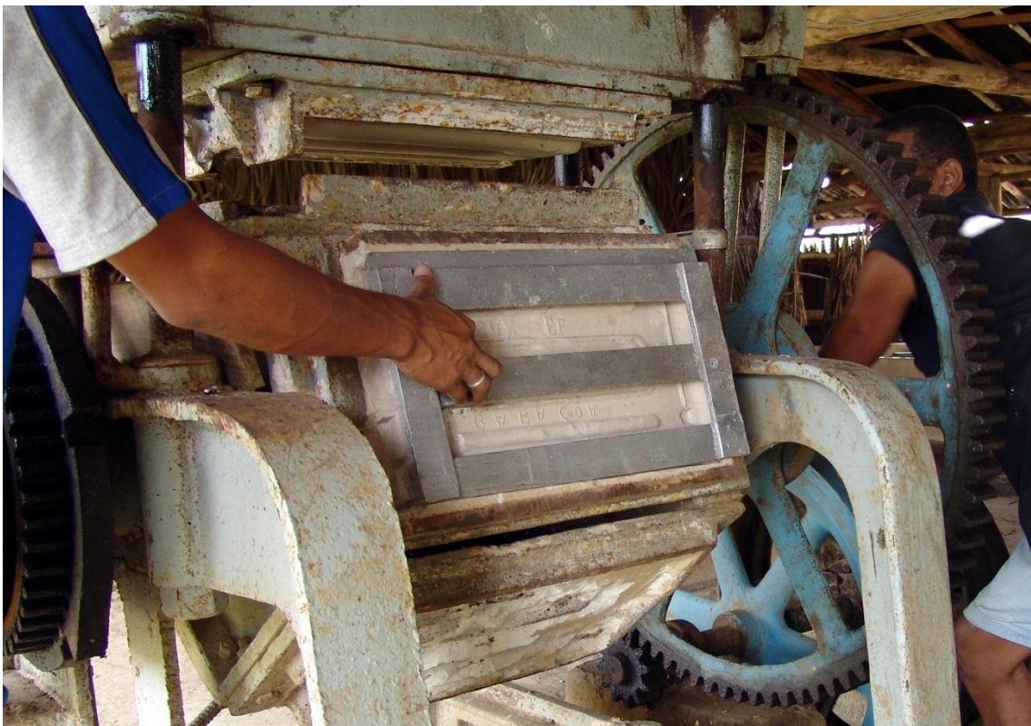
Fotografía 7.9: Fábrica de la Cerámica Roja (Baracoa, Cuba). Simulación de fabricación de tejas francesas. Sobre el molde de yeso, se coloca el molde metálico del anverso de la teja. Captura del 19 de julio de 2007.
