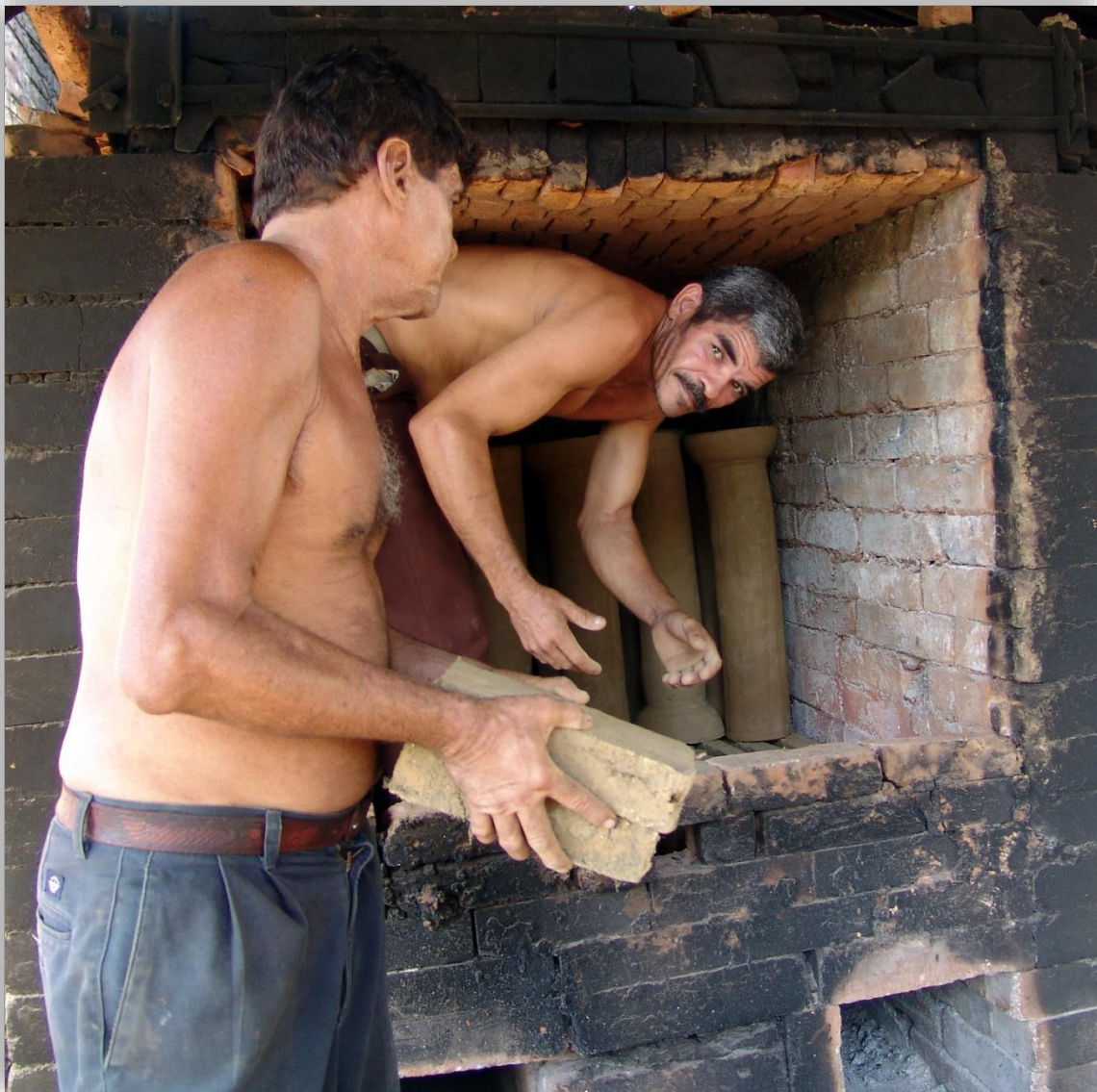
Fotografía 7.20: Fábrica de la Cerámica Roja (Baracoa, Cuba). Carga de tuberías y ladrillos a cocer, en la cámara de guisado de un horno de oxidación, alimentado por leña. En esta alfarería, los hornos se construyen con ladrillos masivos (sin huecos) de arcilla, que son refractarios. Las paredes externas e internas se encuentran a ladrillo visto . En realidad, las cámaras de combustión y de guisado, en estos hornos alfareros, tienen que construirse con materiales refractarios. Se llaman materiales refractarios a aquellos que no dejan pasar al calor (que son opacos, o impermeables, respecto a la transmisión del calor, como sucede en las rocas basálticas masivas y, en este caso, en los ladrillos masivos de arcilla). En consecuencia, el calor que se creara en la cámara de combustión, que en estos hornos puede llegar a los 900° C, no se escapa (hasta ciertos límites). Queda atrapado en la cámara en donde arde la leña y en la cámara de guisado, en beneficio de las piezas cerámicas que se estuvieran cociendo. De todas maneras, se perdería calor a través de las oquedades por donde pasan la tubería bifurcada de inyección de aire, y por el techo, que permite la salida de los humos. La entrada a la cámara de guisado, por donde se carga y se descarga las piezas cerámicas, suelen estar selladas durante la cocción. Captura del 19 de julio de 2007.
