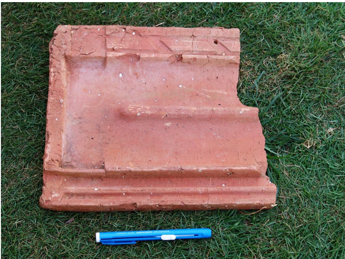
Fotografías 6.155 y 6.156: reverso y anverso de una teja francesa, fabricada en Holguín (Cuba), que fue utilizada en una construcción de la Ciudad de Baracoa, y que pertenece al fondo de documentación del Museo de Baracoa (Cuba). Capturas del 18 de julio de 2007.
