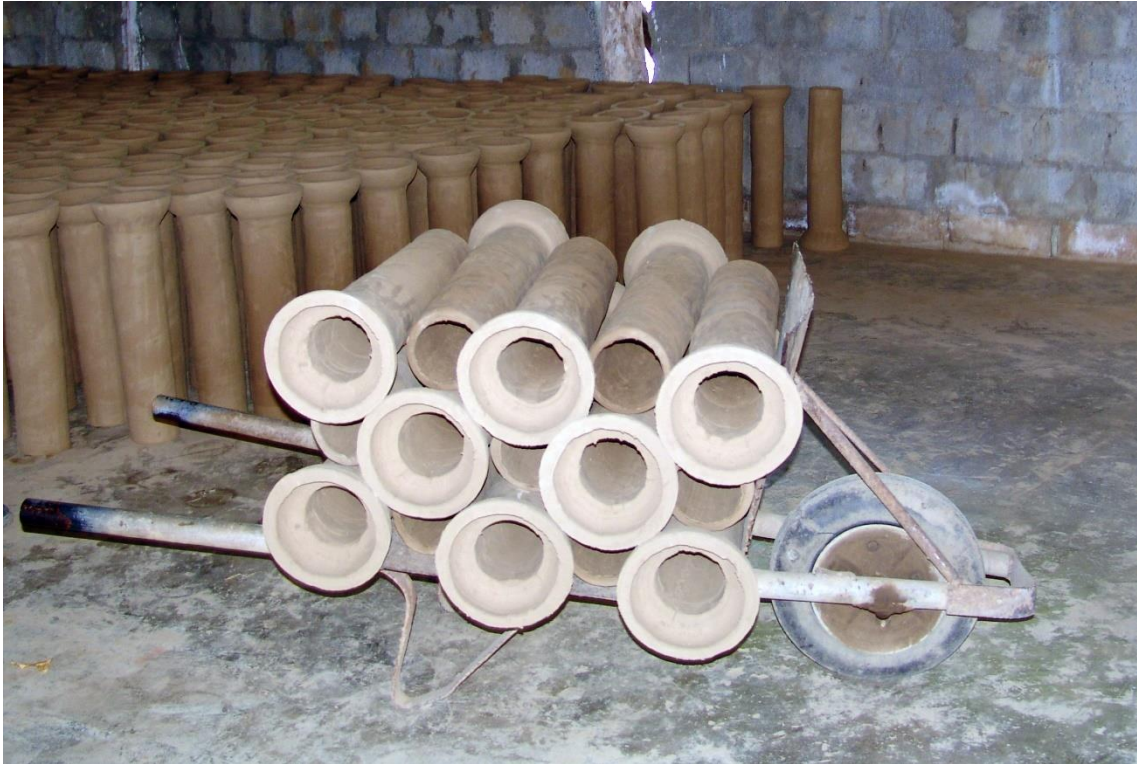
Fotografía 7.16: Fábrica de la Cerámica Roja (Baracoa, Cuba). Fase de secado de las tuberías moldeadas crudas. Captura del 19 de julio de 2007.
