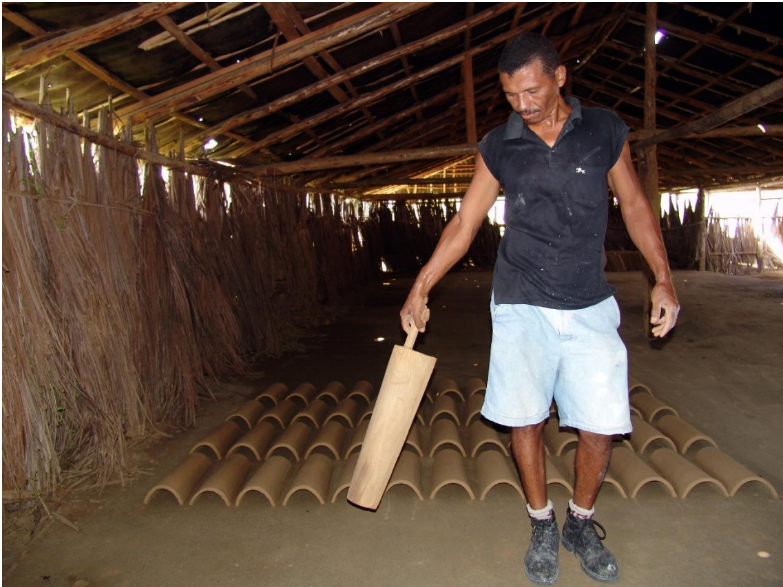
Fotografías 7.10 y 7.11: Fábrica de la Cerámica Roja (Baracoa, Cuba). Molde de madera, con sus reverso y anverso, para fabricar las tejas criollas. En una alfarería enclavada en un territorio de la teja plana francesa, la producción de tejas criolla va destinada a la construcción de redoblones y canaletas. Capturas del 19 de julio de 2007.
