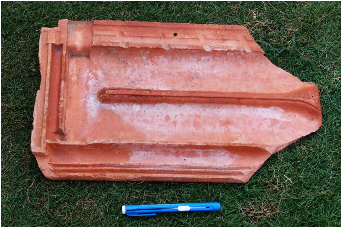
Fotografías 6.141 y 6.142: reverso y anverso de una teja francesa, fabricada en Marsella (Francia), que fue utilizada en una construcción de la Ciudad de Baracoa, y que pertenece al fondo de documentación del Museo de Baracoa (Cuba). Capturas del 18 de julio de 2007.
