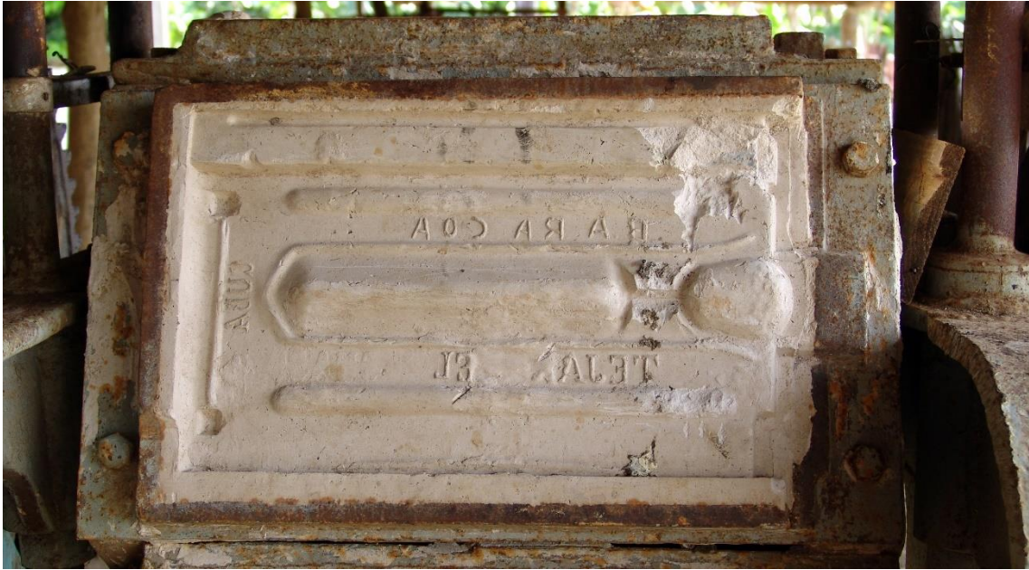
Fotografía 7.8: Fábrica de la Cerámica Roja (Baracoa, Cuba). Detalles de un molde reverso en yeso, enmarcado en la máquina para fabricar tejas francesas. Captura del 19 de julio de 2007.
