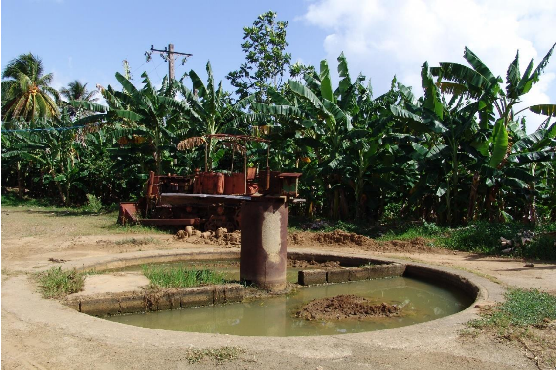
Fotografía 7.2: Fábrica de la Cerámica Roja (Baracoa, Cuba). Estanque destinado a podrir (hidratar) los térreos arcilloso, antes de amasar el barro, para la fabricación de piezas diversas. Captura del 19 de julio de 2007.
