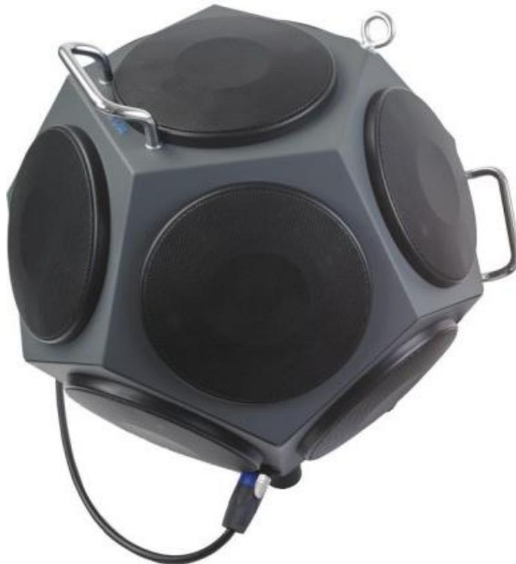
Figura 68. Altavoz BP012 con el cable CN012 conectado
