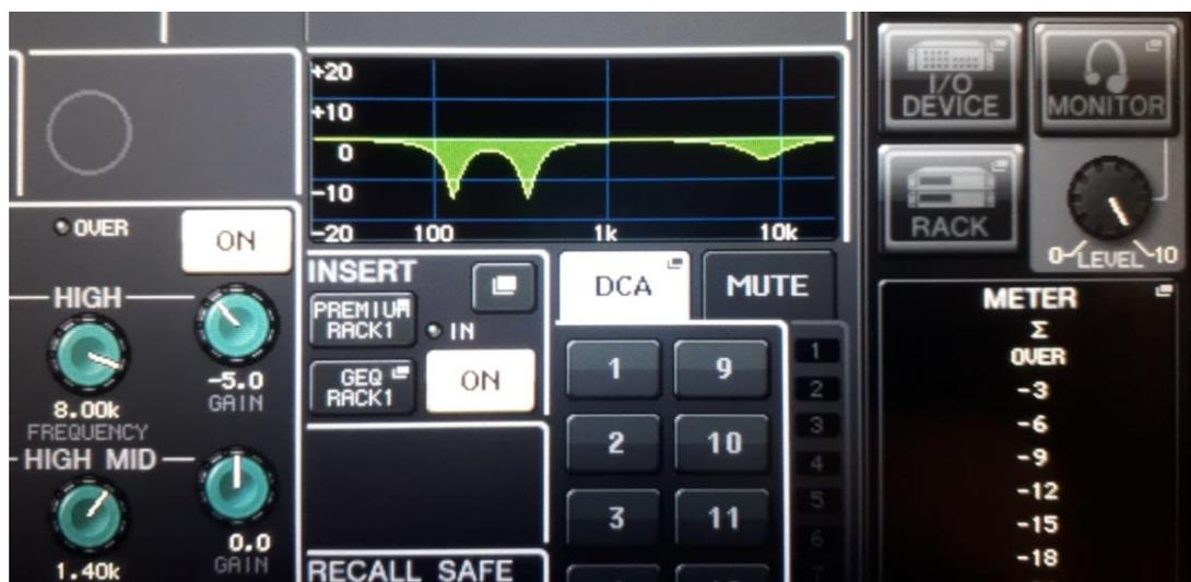
Figura 52. Ejemplo de ecualización de señal de entrada.
