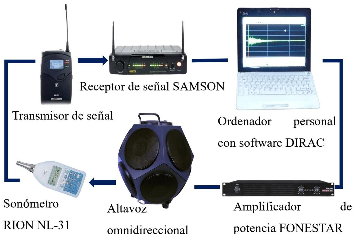
Figura 6. Esquema del conexionado de la medición in-situ
