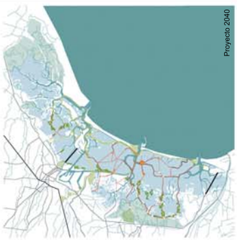
PROYECTO EL PRESENTE PROYECTO PLANTEA LA RECUPERACIÓN DE TODA LA PARTE SUR DE LA LAGUNA MEDIANTE LA EXCAVACIÓN DE NUEVOS CANALES, LA CREACIÓN DE NUEVAS ZONAS DE VERMES ARTIFICIALES (EL CANAL DEL PETRÓLEO) QUE LLEVA DESDE MARGHERA HASTA LA ENTRADA DE MALAMOCCO, SE MEJORAN LAS COMUNICACIONES CON VENECIA CON LA CONSTRUCCIÓN DEL AEROPUERTO SOBRE UNOS BARENES PREEXISTENTES EN EL NOROCCIDENTE DE LA LAGUNA, SE RECONSTRUYE EL PUENTE FERROVIARIO ENTRE CHIÒGGIA Y TIERRA FIRME
