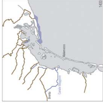
1400 DURANTE EL SIGLO XV, CONTINUÁN LAS OBRAS DE DESVIACIÓN DE LA DESEMBOCADURA DEL RÍO BRENTA, CUYAS AGUAS SE VAN DESVIANDO PROGRESIVAMENTE HACIA EL SUR HACIA EL PUERTO DE MALAMOCCO MEDIANTE LA EXCAVACIÓN DEL CANAL MAYOR
