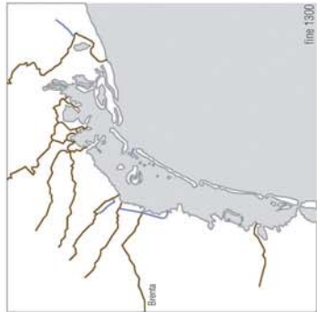
1300 FINALES DEL SIGLO XIV, SE INICIAN LAS OBRAS DE DESVIACIÓN A FINALES DEL SIGLO XV, CONTINUÁN LAS OBRAS DE DESVIACIÓN DE LA DESEMBOCADURA DEL RÍO BRENTA, CUYAS AGUAS SE VAN DESVIANDO PROGRESIVAMENTE HACIA EL SUR HACIA EL PUERTO DE MALAMOCCO MEDIANTE LA EXCAVACIÓN DEL CANAL MAYOR
