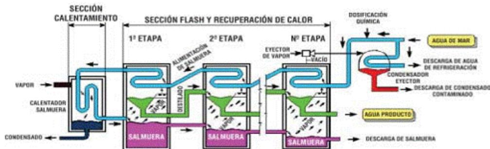
Figura 1. Esquema del Proceso de MSF. [4]
