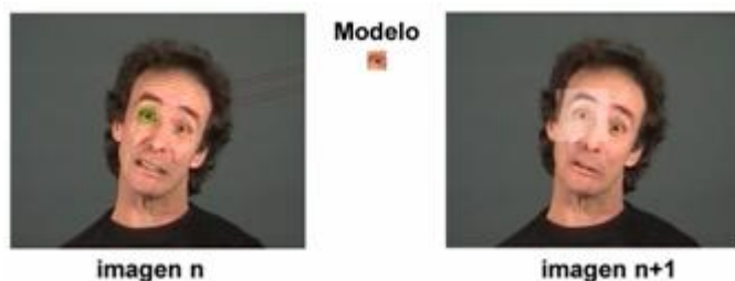
Figura 6. Un modelo extraído en la imagen n , se busca en una zona coherente en la imagen n+1 .
