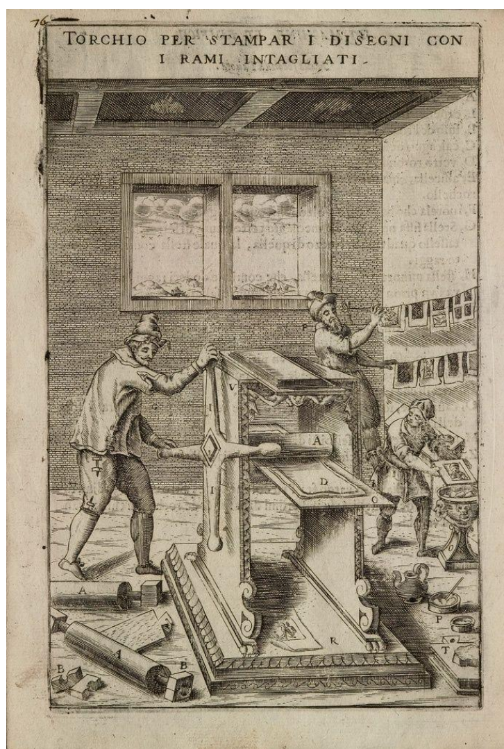
Fig. 57. El taller del impresor. “Prensa para imprimir diseños con cobre tallado”, en: Nuovo teatro di machine et edificii de Vittorio Zonca, Padova: P. Bertelli, 1607, p. 76. Vídeo de Maddalena Salvatori.
