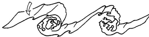
Figura 2.21: Etapas en la transición a la turbulencia de la inestabilidad de *Kelvin-Helmholtz*.
