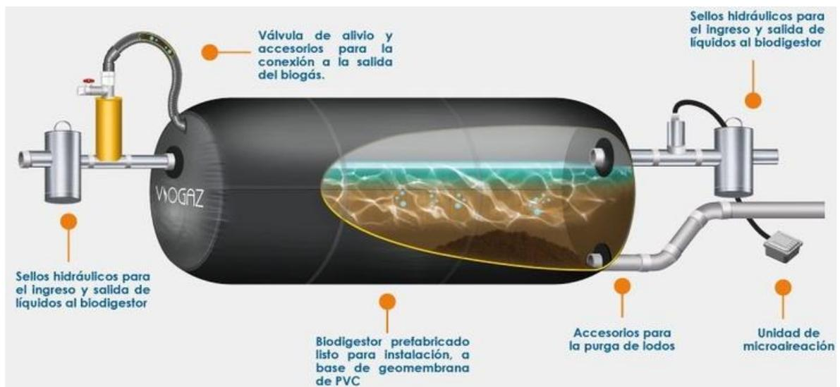
Figura 33. Esquema biodigestor de plástico. Fuente: PuentesDigitales, 2018
