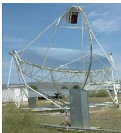
Figura 65. Colector con sistema de concentración de la radiación. Fuente: Garwood, 2005
