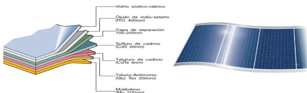
Figura 49. Panel fotovoltaico de capa fina. Fuente: ABB, 2019
