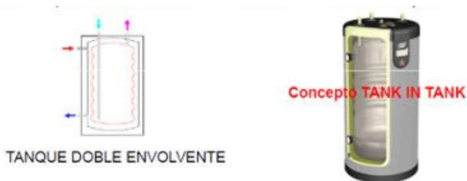
Figura 69. Intercambiador de calor de doble envolvente. Fuente: [www.caloryfrio.com](http://www.caloryfrio.com)
