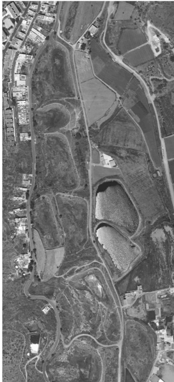
Charcas terrosas: uno de los primeros modelos de charcas que se construyeron en las Islas, aprovechando las zonas de materiales impermeables o sedimentos (origen artificial)
