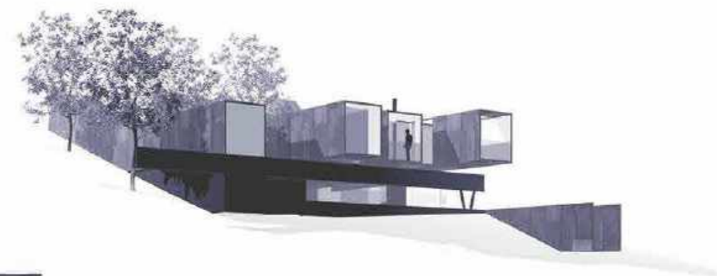
Casa Oruga. (2012) Arquitecto: Sebastián Irarrázaval. Contenedores apoyados sobre los muros de contención.
