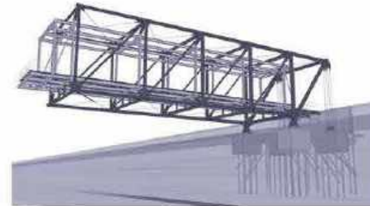
Galería de dibujo de Richard Rogers. (2020) Arquitectos: Rogers Stirk Harbour + Partners. Caja rectangular de acero satinado, compuesto por elementos prefabricados y ensamblados in situ que se apoya sobre una estructura de tubos de acero. La estructura se sostiene sobre la ladera gracias a dos apoyos y otros dos puntos anclados con tirantes.
