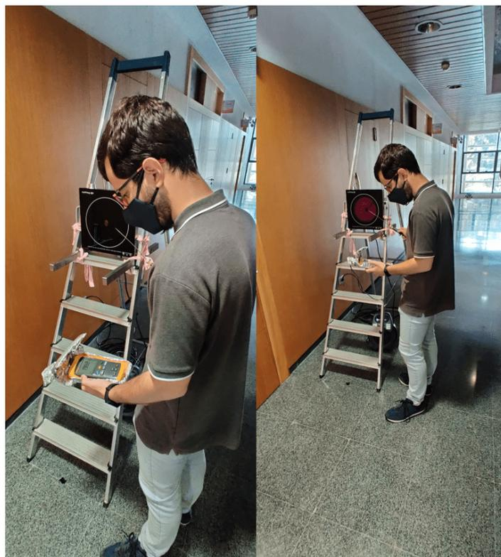
Figura 4.4: Validación de temperaturas con la sonda Fluke 51 II
