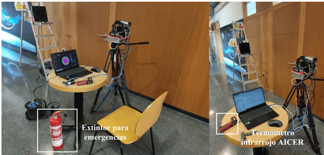
Figura 4.5: Experimento realizado para la calibración de la vitrocerámica
