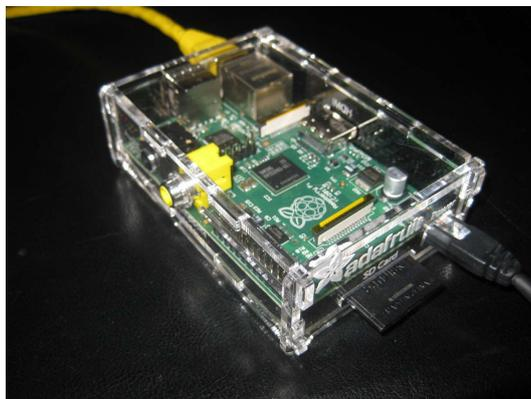
**Figura 10.1:** Raspberry Pi, un posible modelo final para el subsistema cliente
