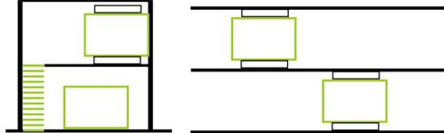
LOS MÓDULOS NO TOCAN LOS FORJADOS, SE MANTIENEN ELEVADOS PARA SEPARARSE COMO COMPONENTE DEL SISTEMA ORGANIZATIVO DE LA PARCELA. DE ESTA MANERA CADA PARTE DEL SISTEMA ACTÚA POR SEPARADO Y, A LA VEZ, ESTÁN UNIDOS Y DEPENDIENTES MEDIANTE LA MEDIANERA.
