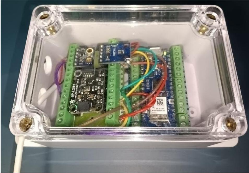
*Figura 38. Sensores y microcontrolador instalados en una caja estanca de protección IP65.*
