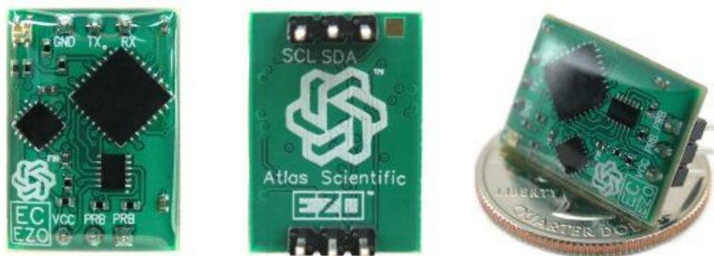
Figura 44. EZO™ Conductivity Circuit. Fuente: Atlas Scientific
