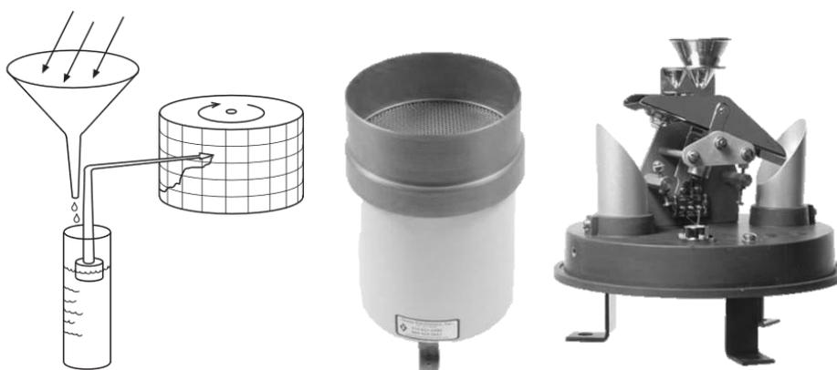
Figura 2. 6. Distintos ejemplos de Pluviógrafo analógico [17].
