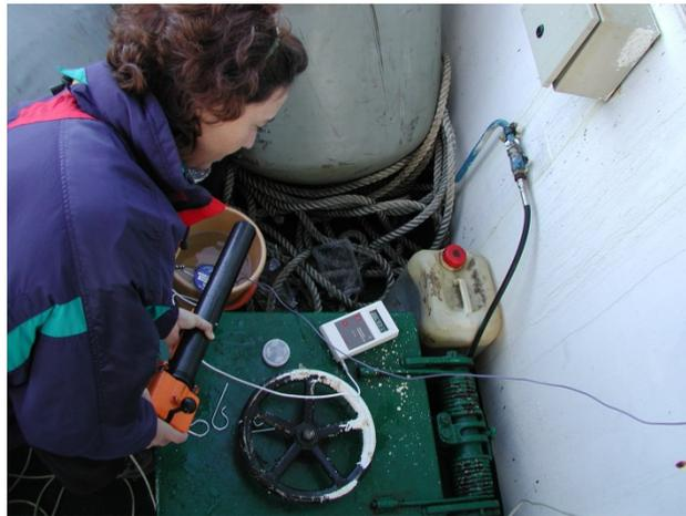
**Figura 2.5:** Lanzadera de XBT y baño de las sondas en un cubo agua a temperatura ambiente exterior para aclimatación. Calibraciones previas a cada lanzamiento con un termómetro de precisión de superficie, CKT100, de Anton Paar.
