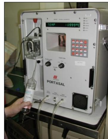
**Figura 2.4** Portasal Guildline 8410A del BIO Hespérides, utilizado para la calibración de la salinidad.
