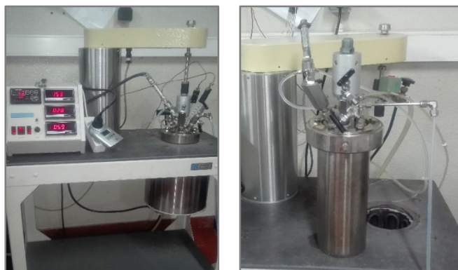
Figura 2. Reactor Parr Instruments Company, USA, empleado en los tratamientos de autohidrólisis no isotérmica
