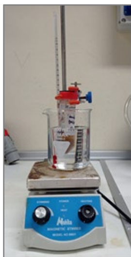
Figura 2. Montaje experimental (a pequeña escala) para la optimización de la extracción de antioxidantes
