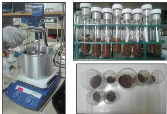
Figura 3. Minirreactores empleados en los tratamientos de autohidrólisis isotérmica
