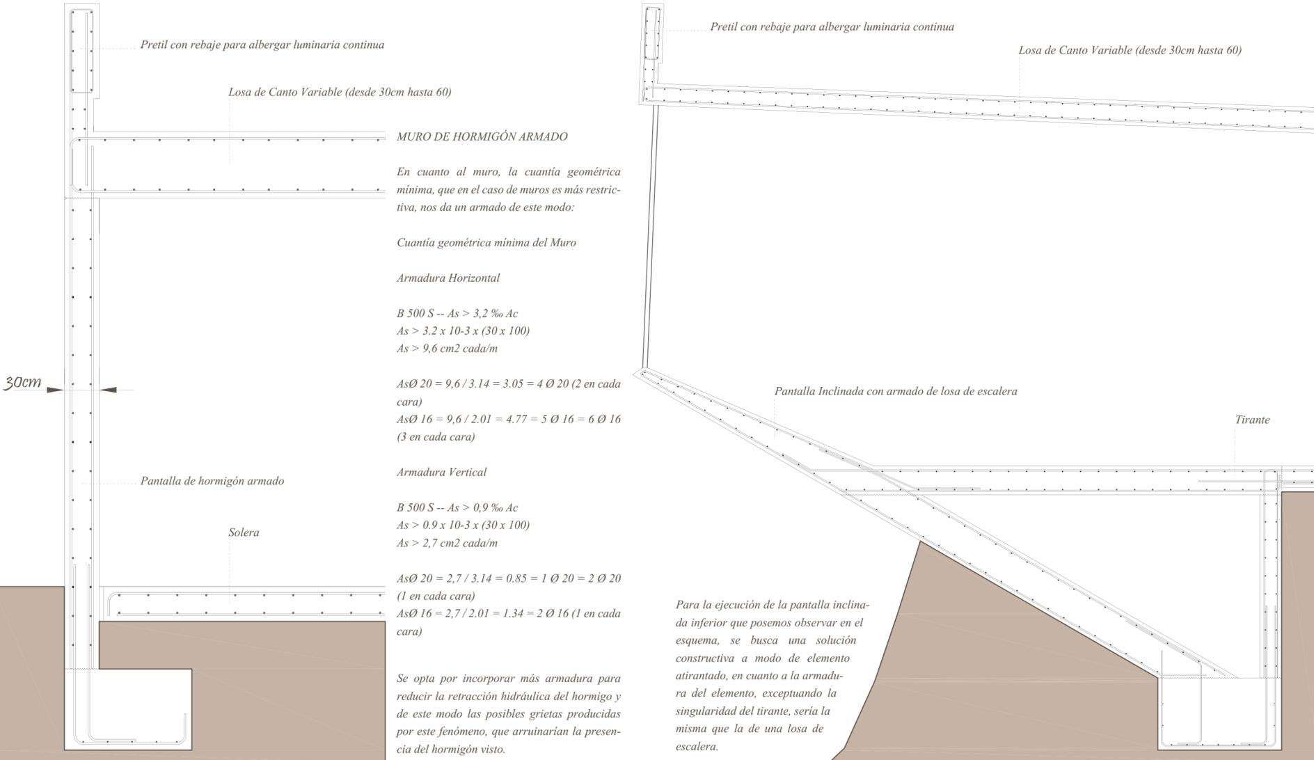
**MURO DE HORMIGÓN ARMADO**
