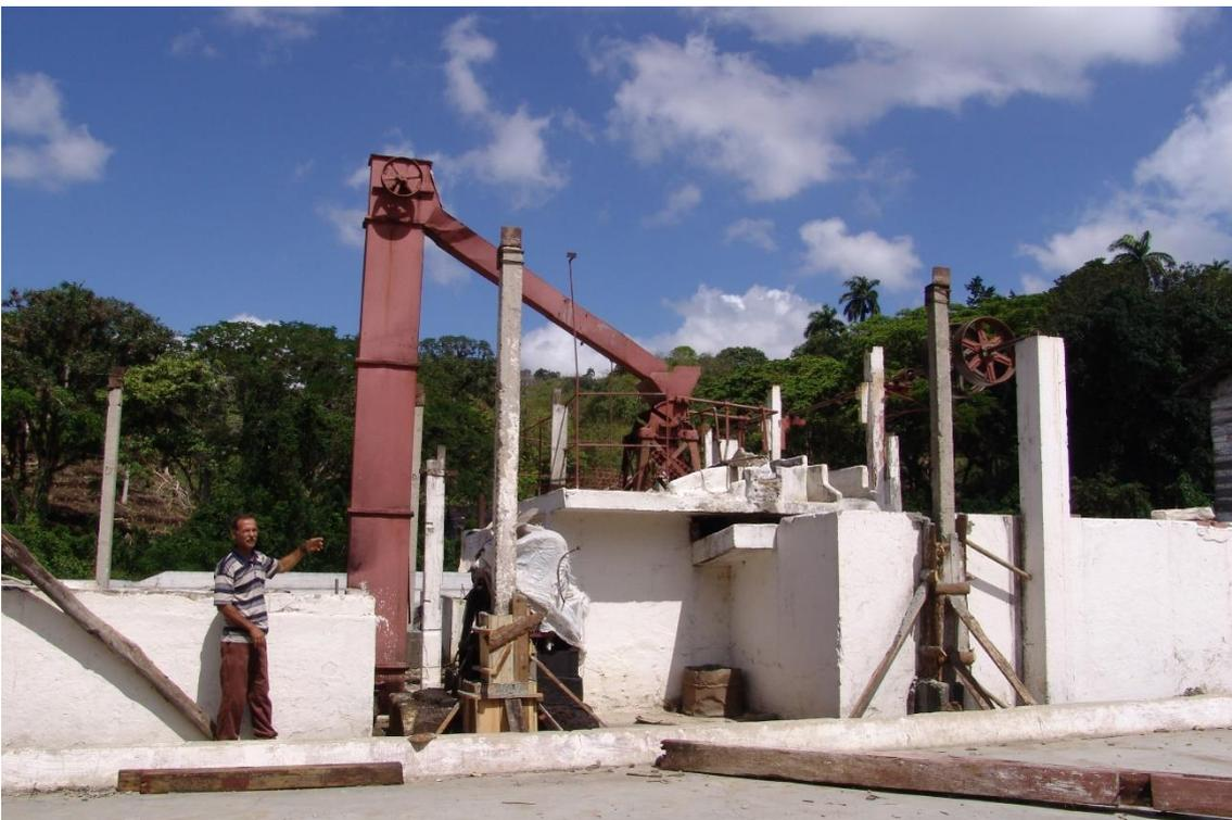
Fotografía 1.43: maquinarias diversas actuales (despulpadoras y descascaradoras, entre otras) para el procesamiento de las cerezas de los cafetos. La Marsellesa (tierra de cafetales, en la Provincia de Santiago de Cuba). Captura del 1 de abril de 2007.
