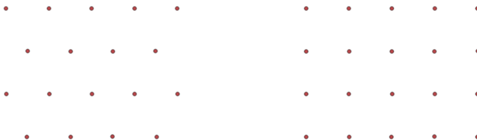
Figura 2.26. Posibles disposiciones de los aerogeneradores. A la izquierda, colocación en tresbolillo. A la derecha, distribución en cuadrícula. Fuente: Elaboración propia.
