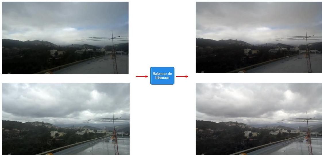
Imagen 71. Esquema general del modo de color cielab antes y después del filtro de balance de blancos.
