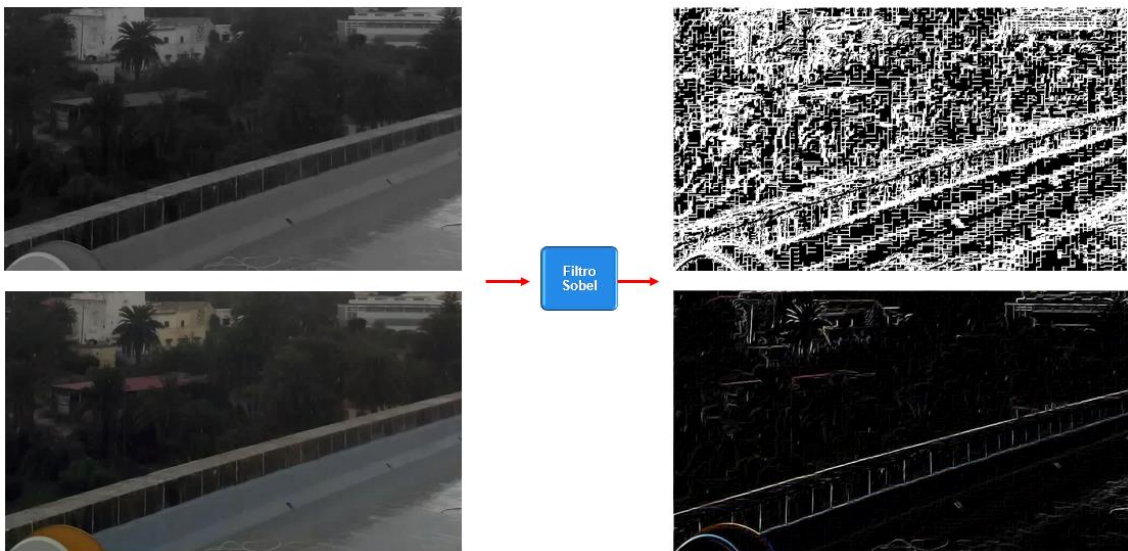
Imagen 104. Imagen de luminancia y Cielab, antes y después, del filtrado de Sobel con lluvia.
