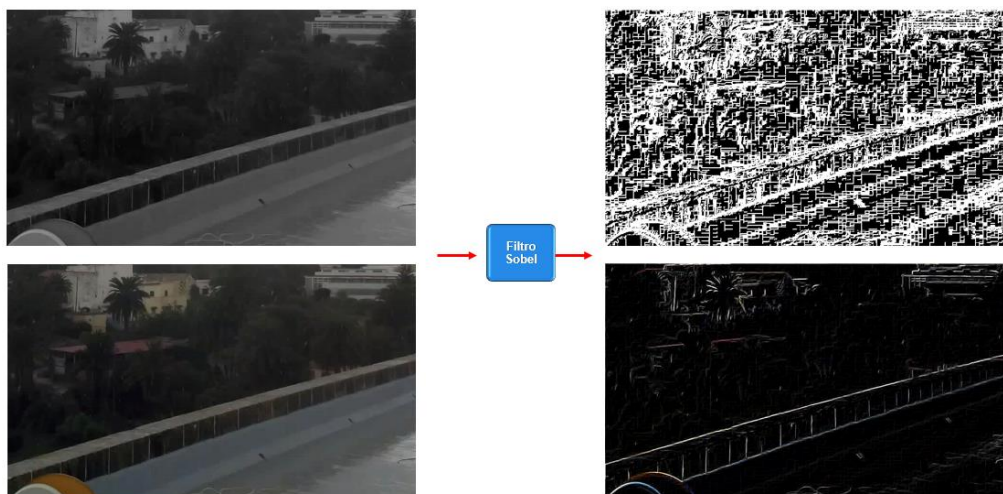
Imagen 44. En esta imagen se ilustra las imágenes antes y después del filtro Sobel. Pertenecen a la cámara Tafira3-FOSCAM y ROI número 8. Introducimos en la parte superior una imagen en blanco y negro y debajo la misma imagen a color.
