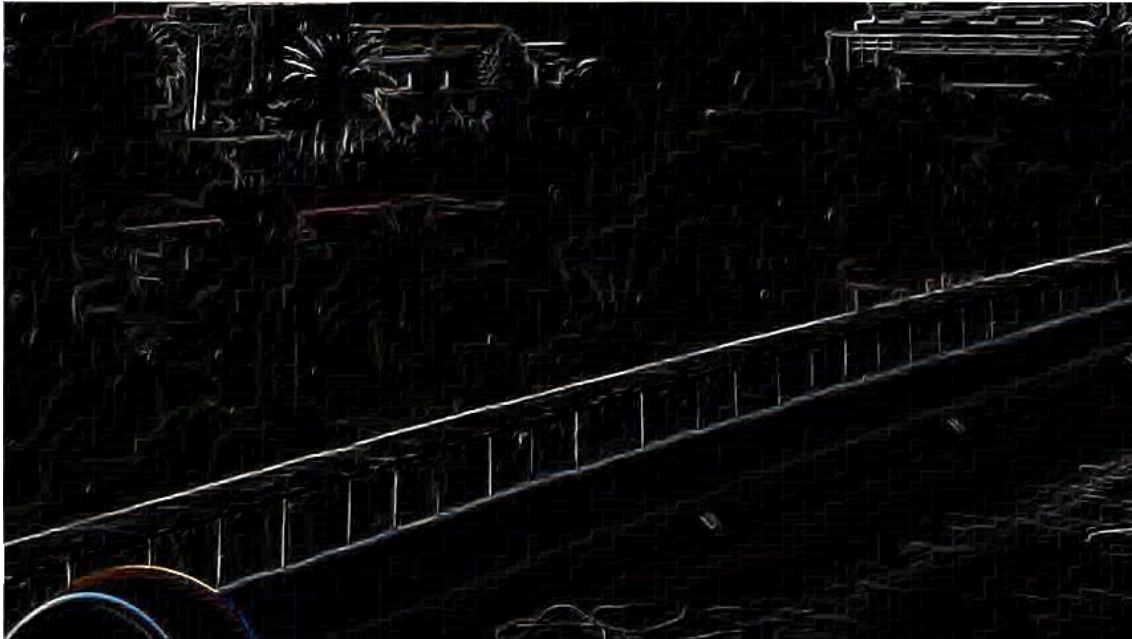
Imagen 82. Filtrado Sobel de la imagen de la cámara FOSCAM de día y con lluvia con el modo de color cielab.
