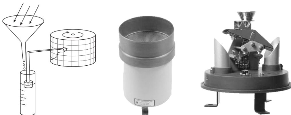
Imagen 17. En la izquierda el pluviómetro de medidor de flotador. En el centro el pluviómetro de medido de balanza. En la derecha el pluviómetro de cubeta basculante.
