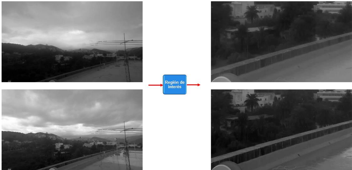
Imagen 74. Esquema general del modo de color de la luminancia antes y después de la extracción de la región de interés.
