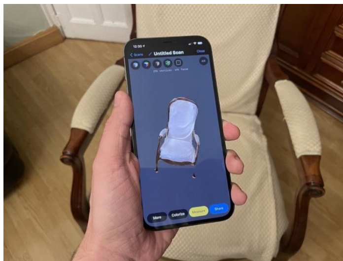
Figura 8: Cámara con sensor LIDAR en el iPhone 12 pro [21]
