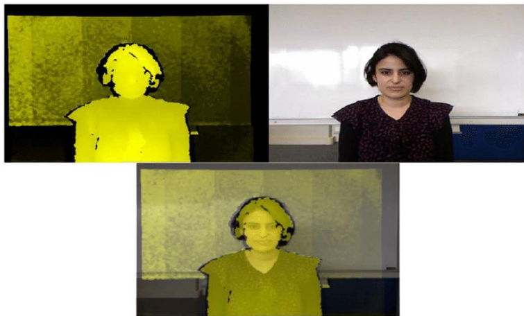
Figura 14: Imagen de profundidad, Imagen RGB e Imagen RGBD [33]
