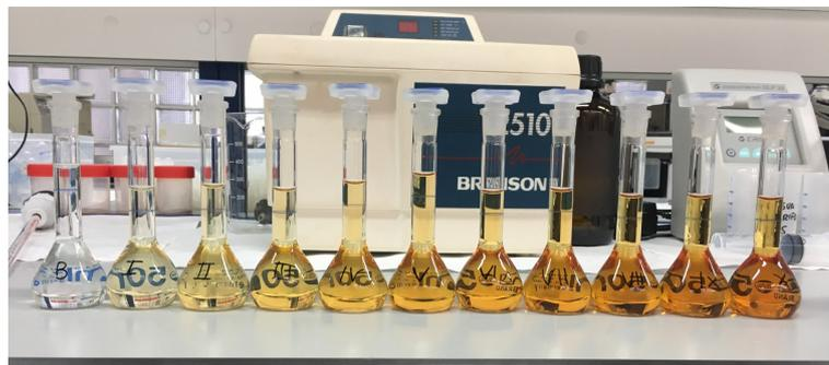
**Figura 3.14** – Patrones para realizar la curva de calibrado para el análisis de  $NH_4^+$ . Se puede ver la graduación de color debido a la formación de la sustancia coloidal.
