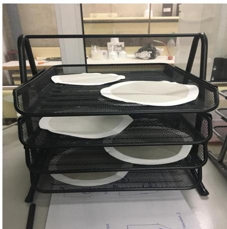
**Figura 3.5** – Colocación de los filtros para su acondicionamiento previo.
