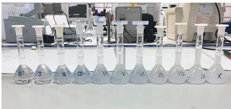
**Figura 3.13** – Patrones para realizar la curva de calibrado para el análisis de  $\text{SO}_4^{2-}$ . Se puede apreciar el aumento de la turbidez en la muestra por la formación de los cristales de  $\text{BaSO}_4$ , de color blanquecino.
