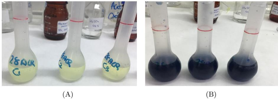
**Figura 3.12** – Cambios de color producidos durante el análisis de Si mediante el método de azul de molibdeno. **A)** Primera etapa: formación del ácido molibdosilícico; **B)** Segunda etapa: formación del complejo coloreado ( $\beta$ -ácido molibdosilícico).
