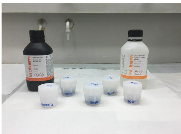
**Figura 3.10** – Bombas de Teflón para realizar la digestión con ácido fluorídrico.
