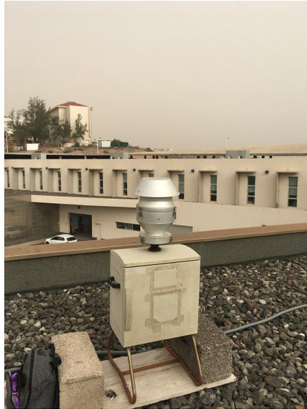
*Figura 3.6* – Captador de alto volumen (CAV) utilizado. La tonalidad sepia de la imagen se debe a la presencia de calima intensa durante la toma de muestras.
