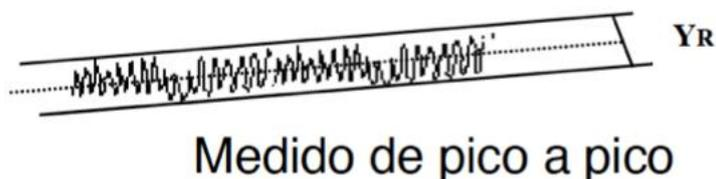
Figura 3. 37.- Ejemplo de la medición de los límites de detección y cuantificación por medio de la señal de ruido (R).
