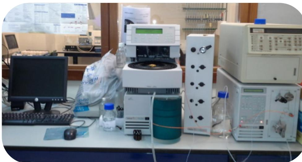
Figura 3. 10 - Equipo HPLC utilizado para la medida de las muestras de ácido fórmico. Fuente: laboratorio CIDIA
