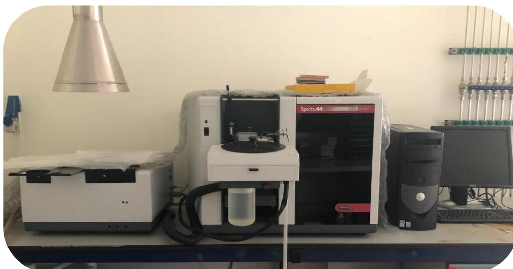
Figura 3. 12.- Espectrofotómetro de absorción atómica modelo SpectrAA 220Z de la casa Varian™ con fuente de alimentación GTA 110Z. Fuente: Laboratorio CIDIA.
