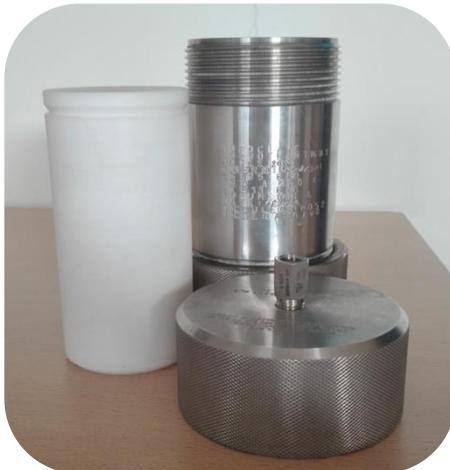
Figura 3. 4 -Reactor hidrotermal ZeoClave de la casa Autoclave-France (vaso de 150 mL). Fuente: Laboratorio CIDIA.
