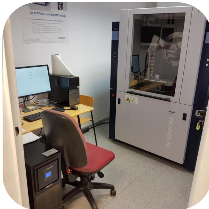
Figura 3. 16.- Equipo DRX de la casa Bruker™ D8 ADVANCE del que dispone el laboratorio CIDIA.
