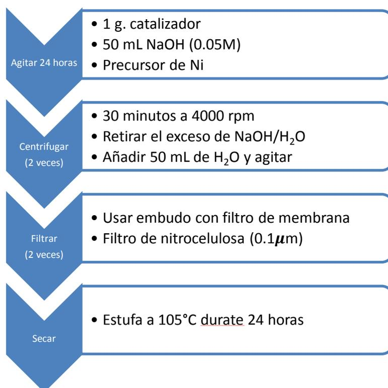
Figura 3. 34. Esquema básico del proceso llevado a cabo para la impregnación de Ni
