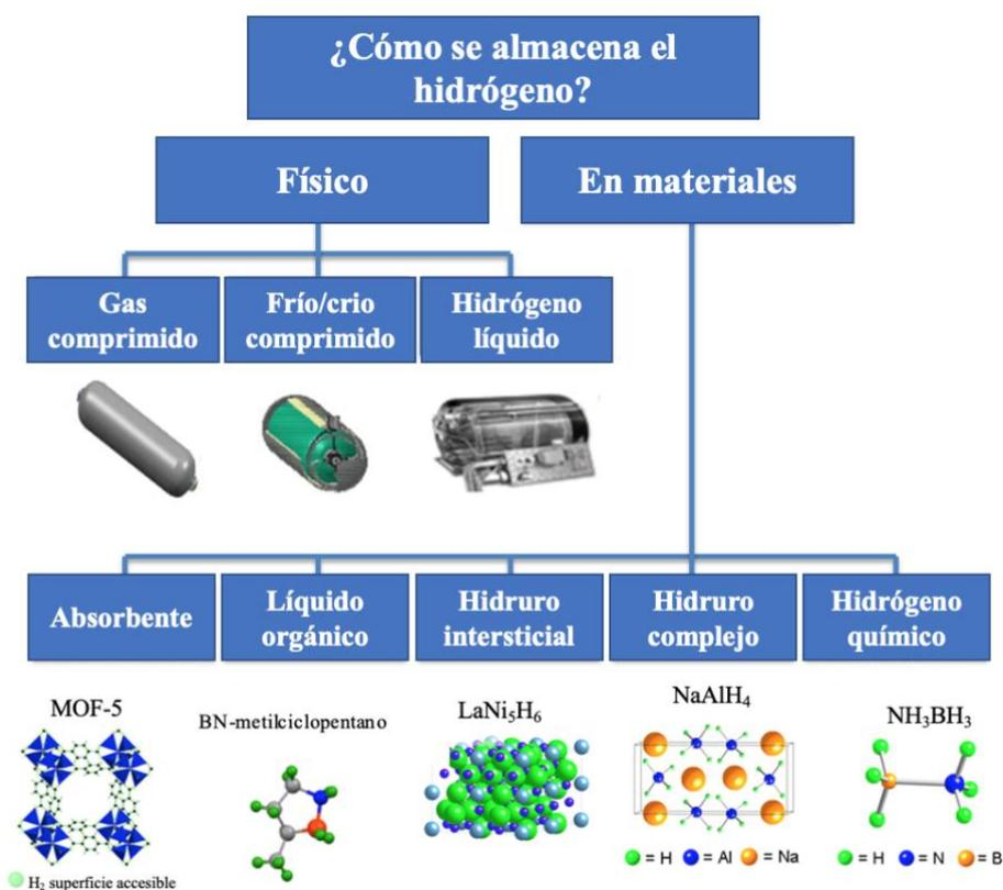
Figura 1. 3.- Métodos de almacenamiento físico y mediante materiales (Tretsiakova-McNally & Makarov, 2016).
