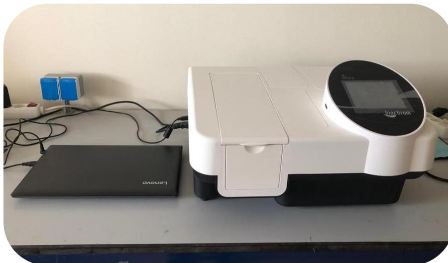
Figura 3. 9.- Espectrofotómetros utilizado para las medidas del formaldehído de las muestras del último capítulo de la Tesis Doctoral, modelo Libra S60 de la casa Biochrom™. Fuente: Laboratorio CIDIA.
