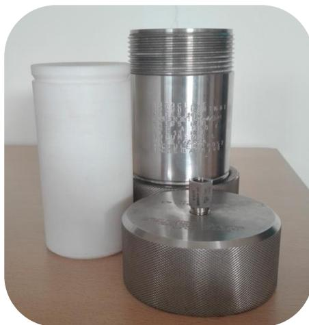
Figura 3. 31. Reactor hidrotérmico utilizado en el laboratorio. Fuente: Laboratorio CIDIA.
