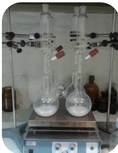
Figura 3. 30. Imagen del sistema de síntesis sol-gel montado en el laboratorio para la síntesis de los semiconductores desarrollados. Fuente: Laboratorio CIDIA.
