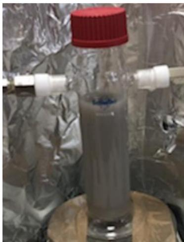
Figura 7. 3.-Reactor con SG700-0.27%<sub>o</sub>p/pPt-0.38%<sub>o</sub>p/pNi, en el que se quedó pegado el fotocatalizador al vidrio y no pudo ser recuperado.
