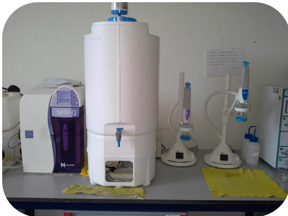
Figura 3. 1 -Equipo de agua ultrapura Integral Millipore (Agua MQ). Fuente: Laboratorio CIDIA.
