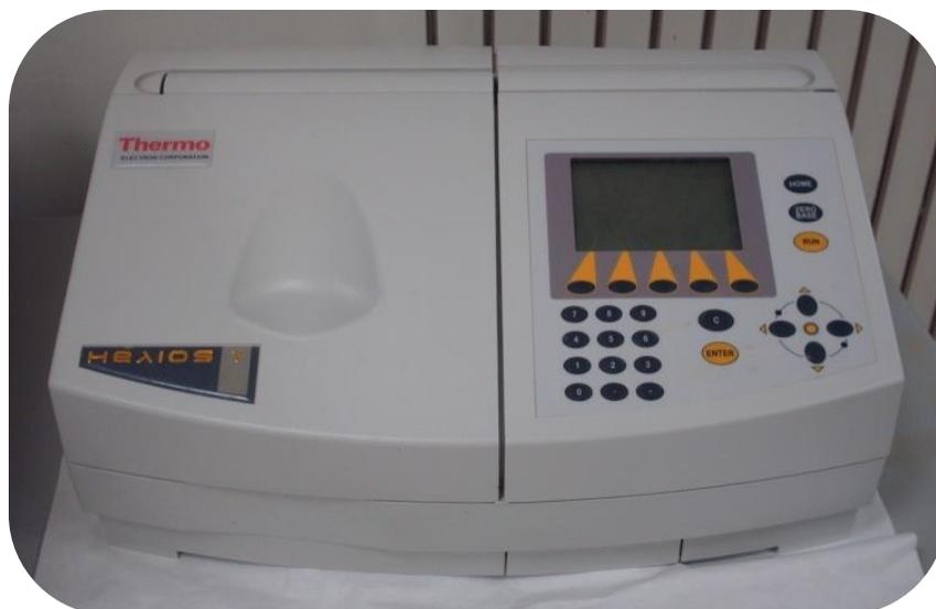
Figura 3. 8.-Espectrofotómetros utilizado para las medidas del formaldehído de la mayoría de las muestras, modelo Hélios y UV-Vis. Fuente: Laboratorio CIDIA.
