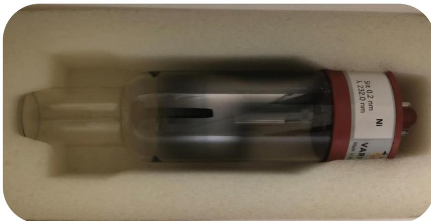
Figura 3. 13.- Lámpara de cátodo hueco de níquel de la casa Varian<sup>TM</sup>. Fuente: Laboratorio CIDIA.
