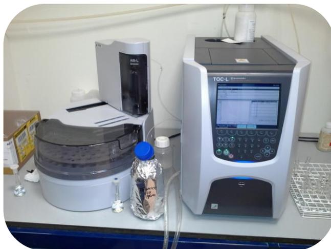
Figura 3. 11 -Equipo de Carbono Orgánico Total (TOC). Fuente: laboratorio CIDIA
