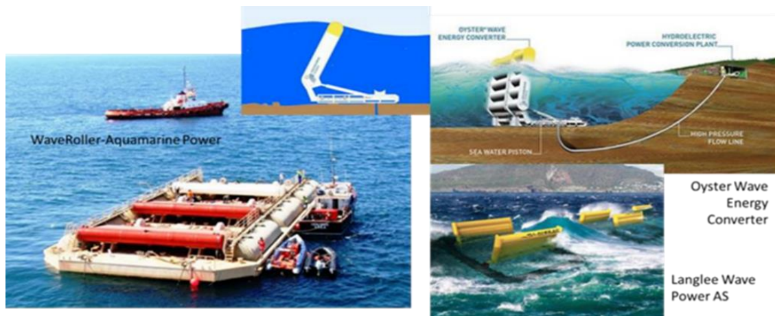
Figura 8. Dispositivos de empuje horizontal: Waveroller, Oyster, Langlee.
