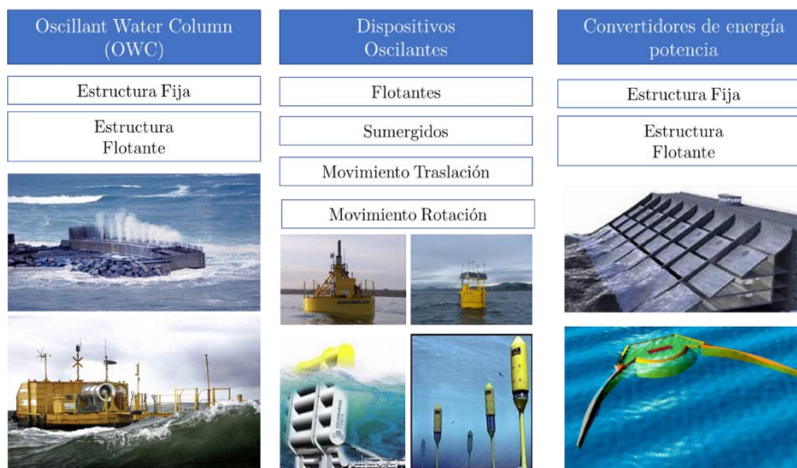
Figura 5. Clasificación de tecnologías de conversión en función de su principio de funcionamiento. Fuente: Elaboración propia a partir de [4] [7].
