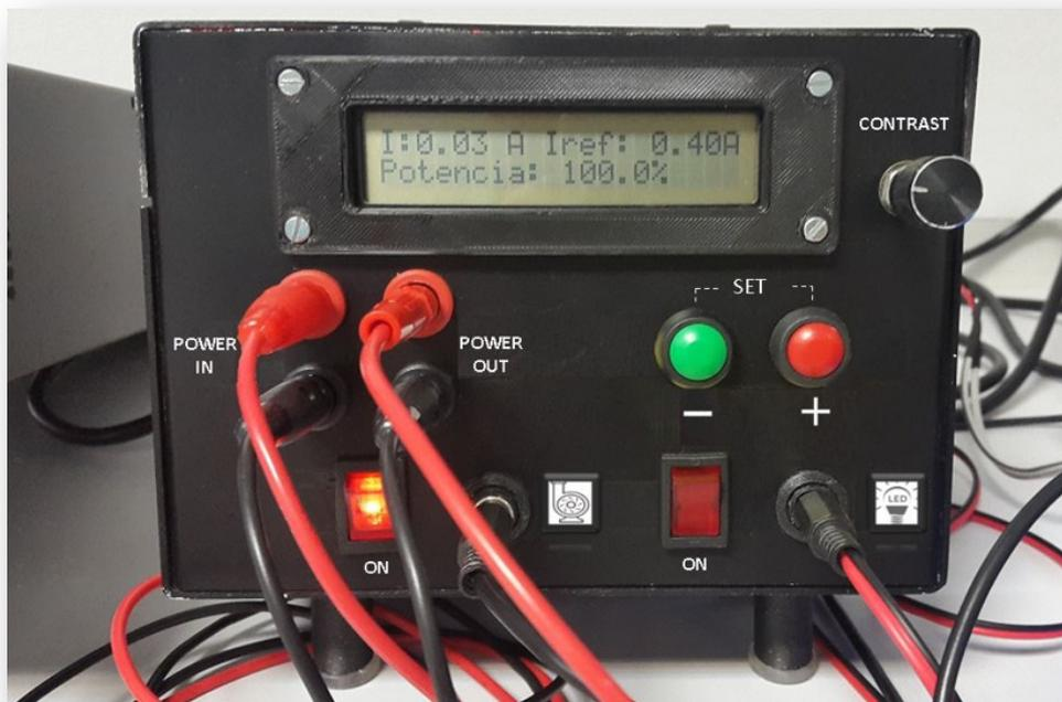
Fig. 3.8. Dispositivo de control automático de agitación del baño electrolítico (DCAB).
