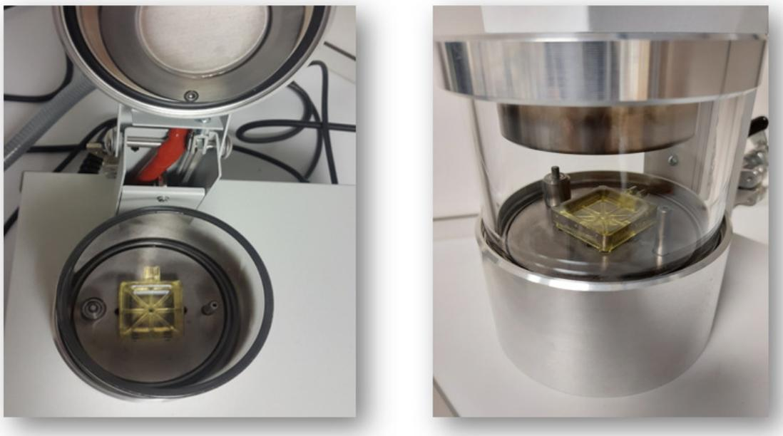
Fig. 4.19. Modelo funcional en la cámara de descarga
