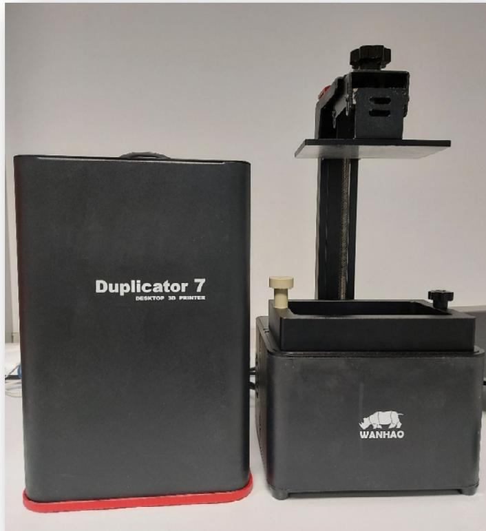
Fig. 4.2. Máquina de impresión 3D Wanhao Duplicator 7.
