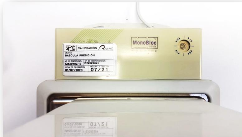
Fig. 3.42. Etiqueta de calibración del equipo de medición.
