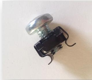
Fig. 3.31. Componente para la fijación de la probeta de ensayos.
