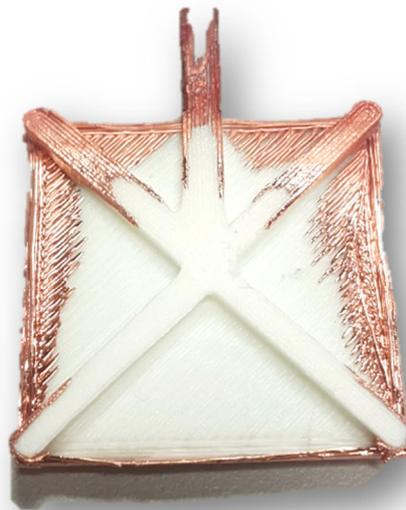
Fig. 3.62. Crecimiento no controlado en la parte trasera del modelo funcional.
