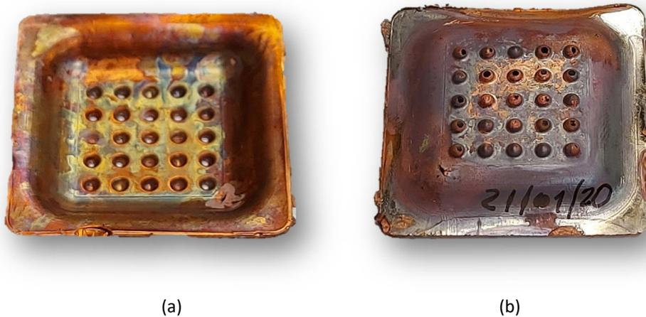
Fig. 5.23. Ensayo 4.1. Cáscara depositada. (a) Cara frontal. (b) Cara trasera o funcional.
