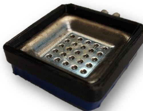
Fig. 3.65. Preparación del modelo funcional con máscara previo a la deposición.
