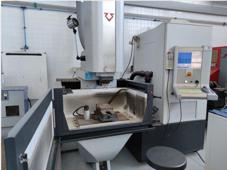
Fig. 5.39. Máquina de electroerosión por penetración ONA NX3.
