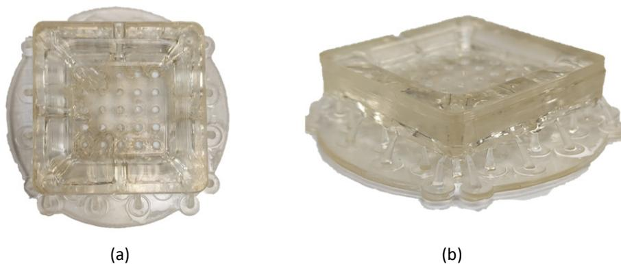
Fig. 4.5. Modelo funcional. (a) Resultado. (b) detalle de los soportes.
