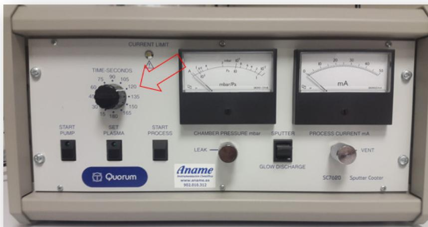
Fig. 4.30. Manejo del SC7620: ajuste tiempo de operación.
