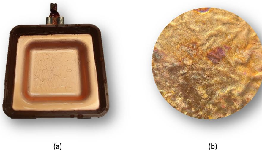
Fig. 5.16 Ensayo 2.3. (a) Acabado de la superficie. (b) Textura vista al microscopio.
