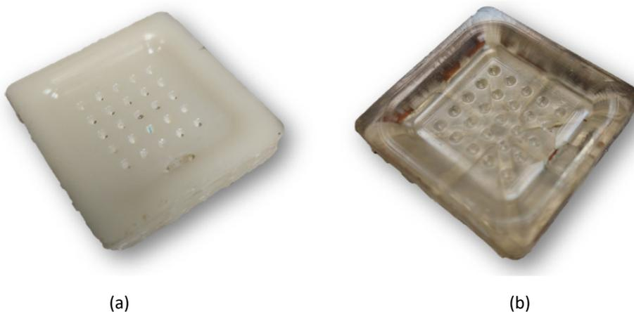
Fig. 4.4. Modelo funcional fabricado. (a) Monocure 3D blanca. (b) Monocure 3D transparente.
