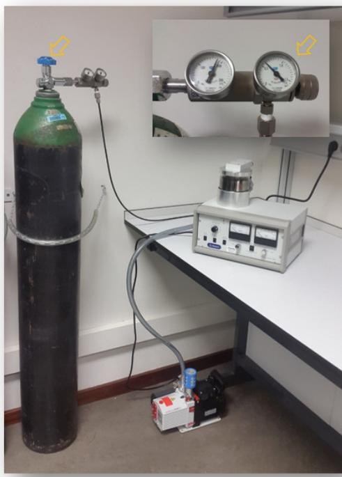
Fig. 4.26. Manejo del SC7620: control del paso de gas.
