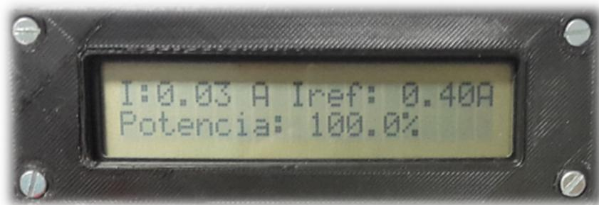
Fig. 3.20. Pantalla de visualización del DCAB. Ejemplo de visualización en modo automático.
