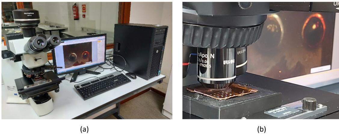
Fig. 4.53. (a) Microscopio de medición Olympus BX51. (b) Proceso de inspección.
