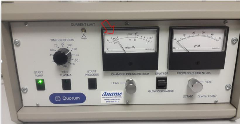
Fig. 4.32. Manejo del SC7620: configuración con válvula *LEAK* abierta.
