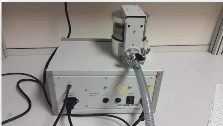
Fig. 4.25. Manejo del SC7620: encendido del equipo.
