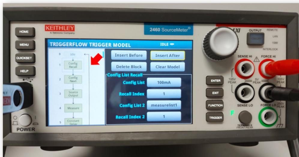
Fig. 4.41. KEITHLEY 2460 SourceMeter®: pantalla de programación.
