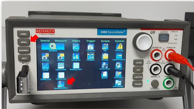
Fig. 4.46. KEITHLEY 2460 SourceMeter®: botón para acceso a los buffers.
