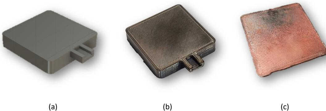
Fig. 4.16. Modelo plano. (a) Modelado. (b) Modelo fabricado. (c) Cáscara obtenida.
