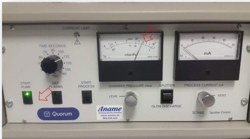
Fig. 4.31. Manejo del SC7620: generación de vacío.
