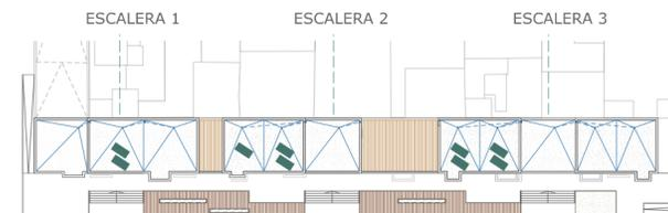
DISPOSICIÓN CAPTADORES EN CUBIERTA
