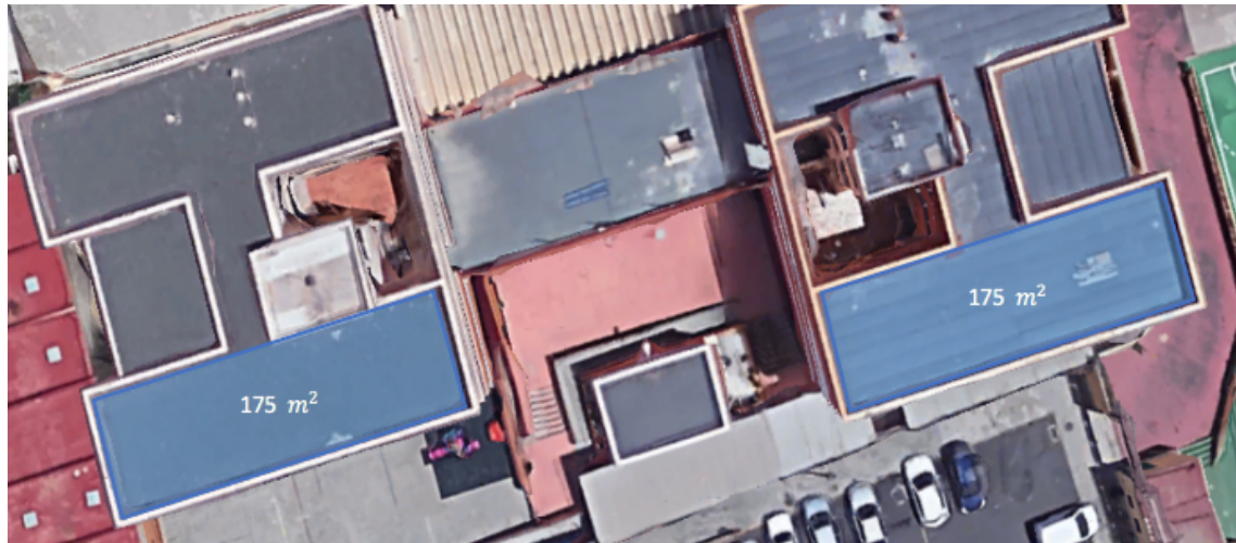
Figura 21. Área reservada para la instalación fotovoltaica
