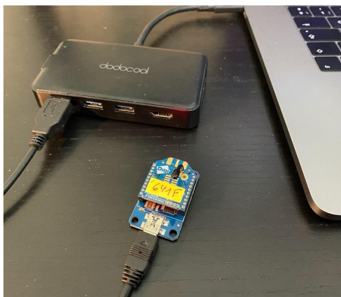
Figura 50. Módulo XBee® conectado a ordenador portátil.
