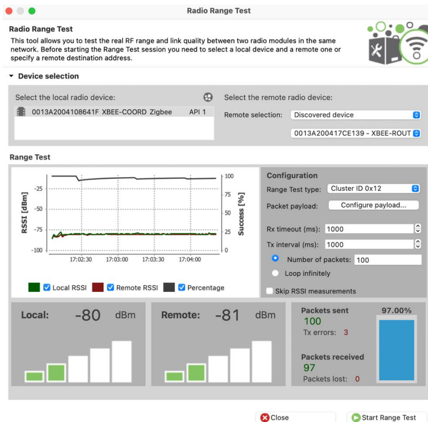
Figura 68. Pruebas en interiores: niveles de potencia de señal.
