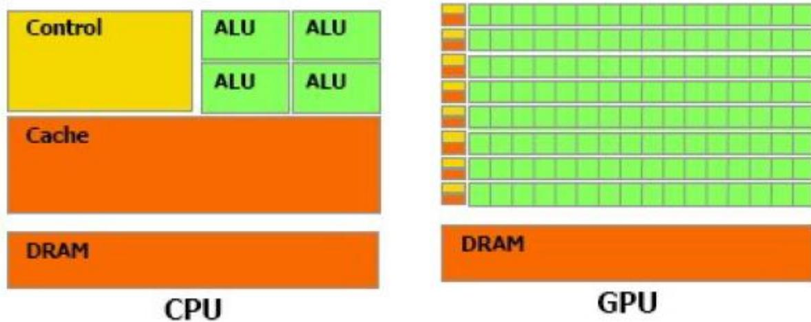
Figura 19. Esquemas básicos de CPU y GPU.
