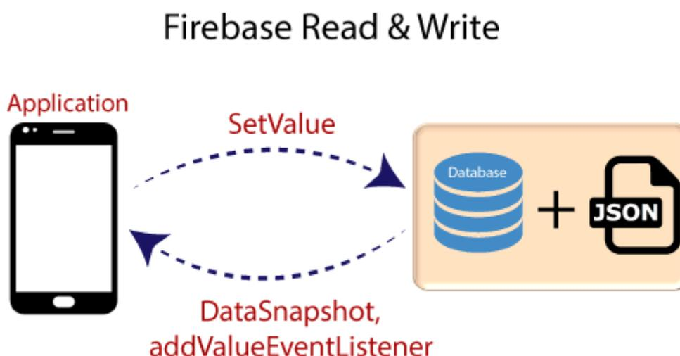
**Figura 70.** Ilustración que representa la interacción entre la App Android y Firebase [45]
