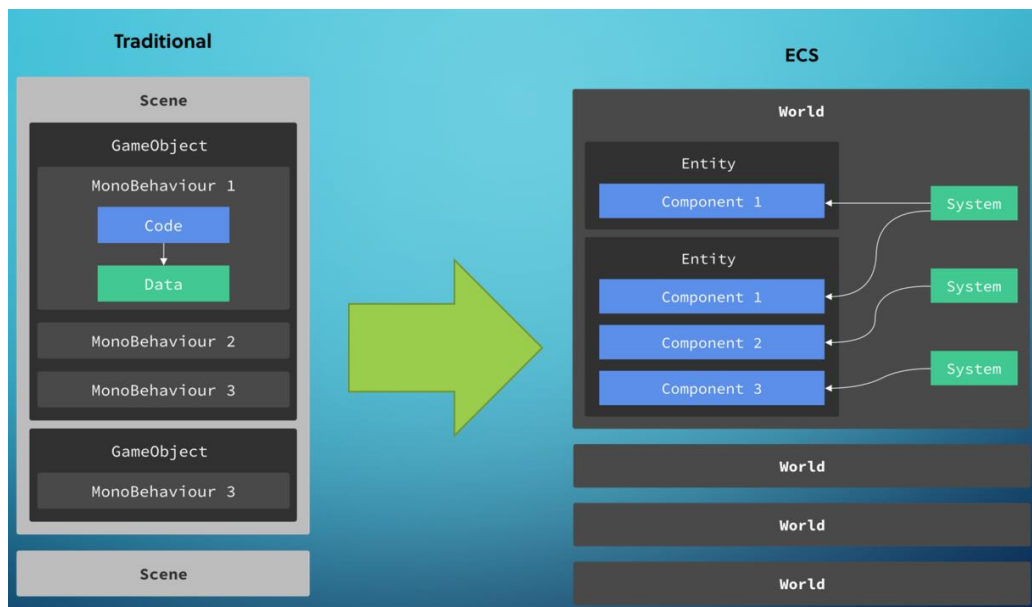
Ilustración 6 Estructura de un programa creando un objeto en Unity de manera general, a la izquierda, en comparación a la creación de un objeto en Unity, utilizando ECS, a la derecha. Fuente: https://www.improbable.io/blog/unity-ecs-1
