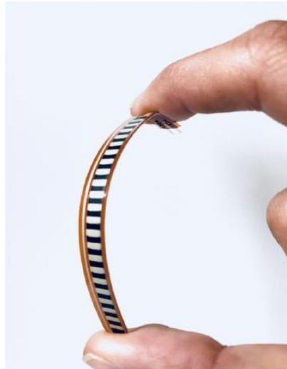
En la Figura 6 se representa el circuito propuesto para la conexión de los sensores utilizando una plataforma basada en MCU [10], y el cual se ha tomado como referencia para el montaje del circuito basado en el dispositivo Argon utilizado en el presente TFG. Al combinar el sensor de flexión con una resistencia estática para crear un divisor de tensión, es posible generar una tensión variable que pueda leerse mediante un convertidor analógico-digital integrado en el microcontrolador.
