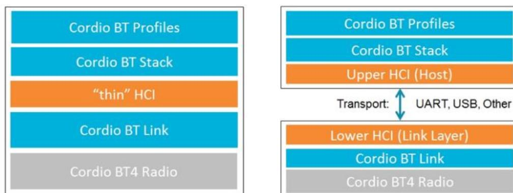
Ilustración 26: Pila *Cordio* en un único chipset y en un dual chipset [12].
